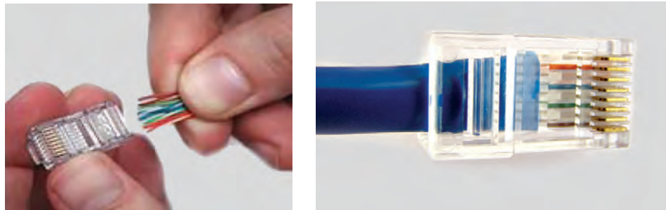
شکل ۲۸- قرار دادن سیم‌ها در سوکت
