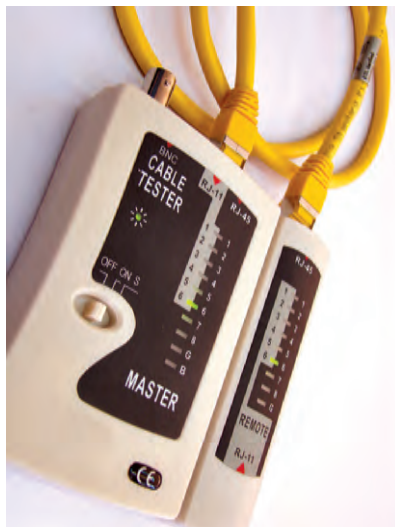
شکل ۲۰- تست کابل شبکه
