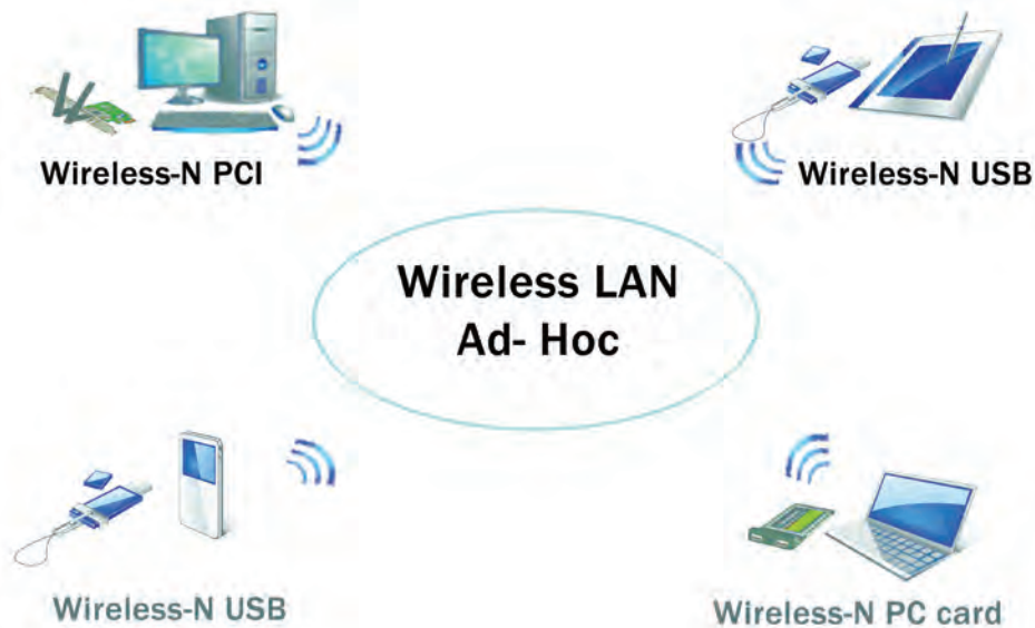
شکل ۳- پیکربندی شبکه بی سیم به صورت Ad Hoc
