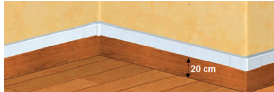
شکل ۵۲ - فاصله داکت یا ترانک از کف
