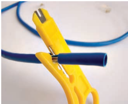
شکل ۲۵- لخت کردن سر کابل
