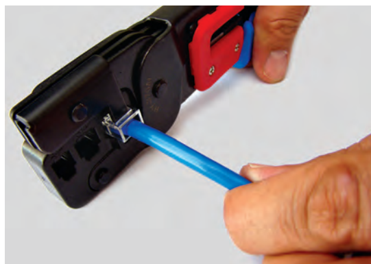
شکل ۲۹- پرس کردن سوکت RJ45
