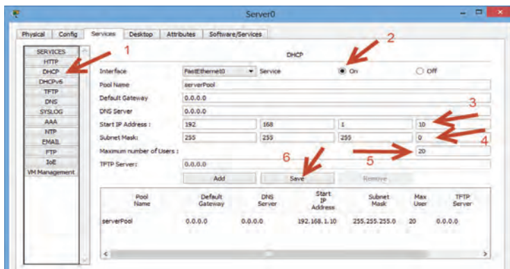
شکل ۲۹- تنظیمات سرویس DHCP روی سرور
