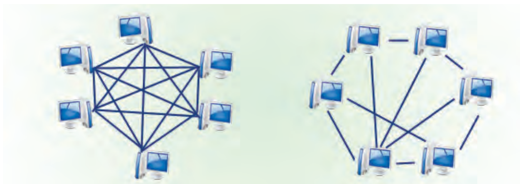
شکل ۱۶- همبندی مش ناقص و کامل
