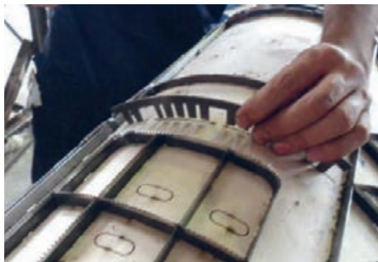
شکل ۱۳۳- قرار دادن تیغ‌ها در سیلندر
