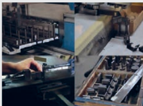
شکل ۱۰۲- خم کن با قطعات مختلف آن
