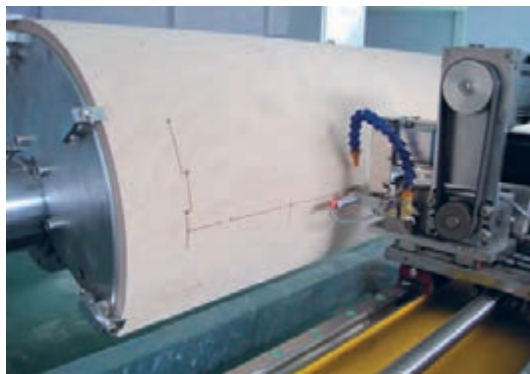
شکل ۱۲۶- برش تخته قالب با دستگاه اره CNC
