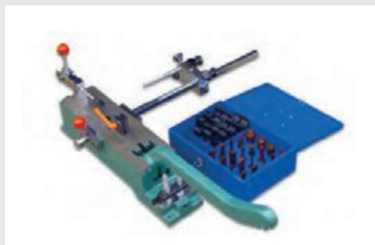
شکل ۱۰۳- دستگاه خم کن دستی
