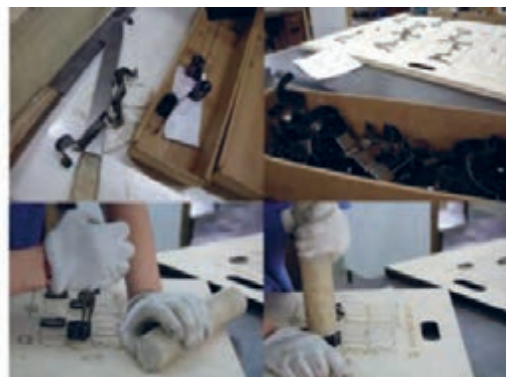
شکل ۱۰۴- قرار دادن تیغ‌ها در قالب
