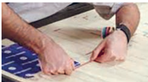
شکل ۹۳- نحوه چسباندن طرح روی قالب
