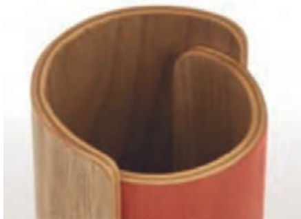
شکل ۱۳- ویژگی انعطاف پذیری تخته‌های چند لایه
