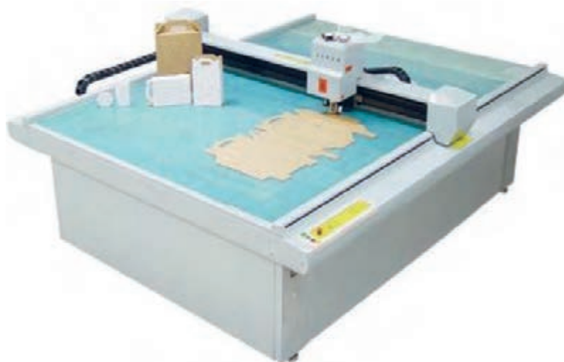
شکل ۷۰- دستگاه نمونه ساز کاتر پلاتر
