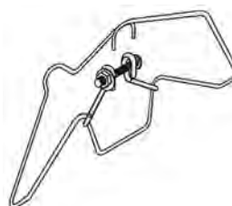
بست اتصال رفلکتور و لوله
