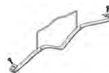
بست اتصال رفلکتور به سقف
