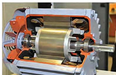
شکل ۱۶- نمایش بلبرینگ و روتور موتور الکتریکی
