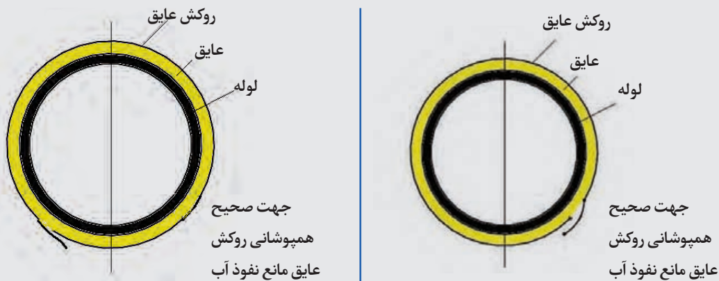
شکل ۶- جهت صحیح روکش عایق
