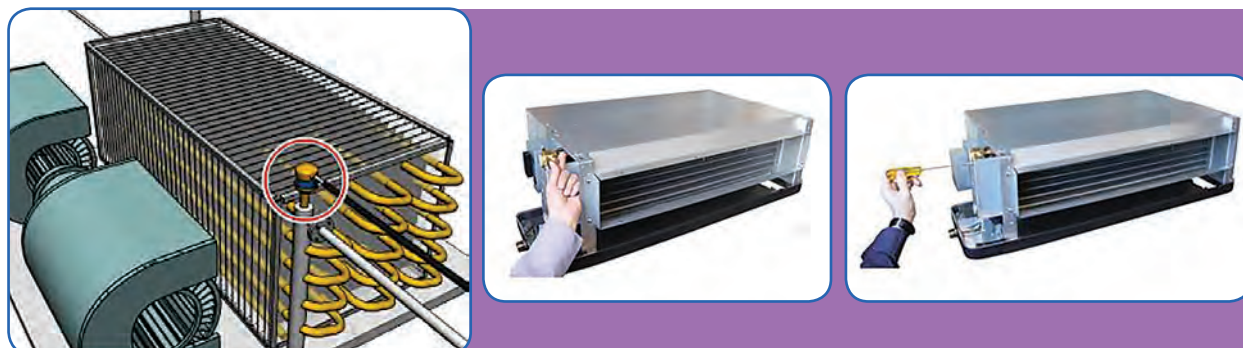
شکل ۲- هواگیری فن کویل
