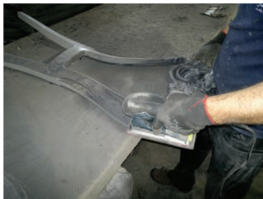
شکل ۳۱-۵ پرداخت پشت صندلی با سنباده لرزان
