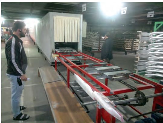
شکل ۴۰-۵- خروج قطعات از تونل
