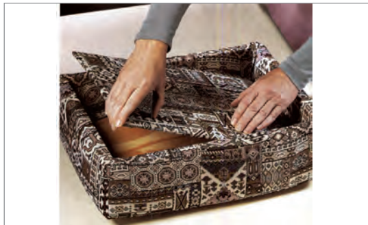
شکل ۴-۳۸- پوشش در صندوقچه از طرف داخل
