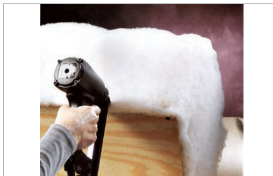
شکل ۴-۳۹- نصب اسفنج به بدنه صندوقچه
