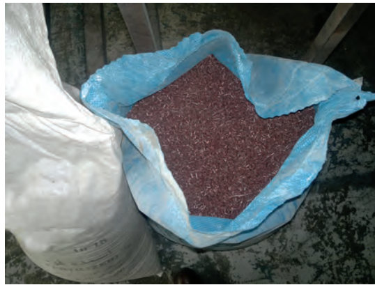
شکل ۵-۱۹- مواد اولیه تهیه شده به شکل گرانول
