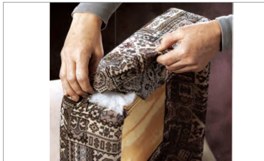
شکل ۴-۳۷- تنظیم پارچه گوشه‌ها
