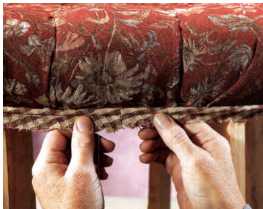
شکل ۴-۶۹- اندازه گیری و نصب سرمه
