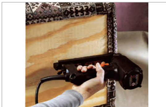
شکل ۴-۴۰- نصب پارچه در زیر صندوقچه
