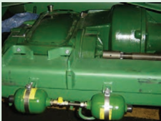
شکل ۳۷- آکومولاتور سیستم تعلیق هد کمباین جاندر ۱۰۵۵
