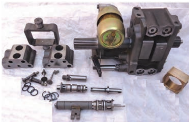
شکل ۴۸- پمپ هیدرولیک MF۲۸۵
