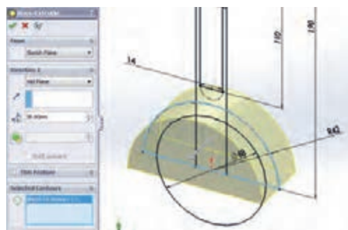
الف - حجم قطعه به روش Mid Plane و به مقدار ۳۸ میلی متر
