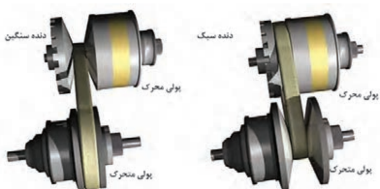
شکل ۶۲- نحوه عملکرد پولی‌های با قطر متغیر
