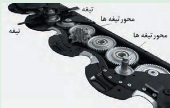
شکل ۵۱ - چرخ دنده‌های محرک تیغه‌ها در دروگر بشقابی
