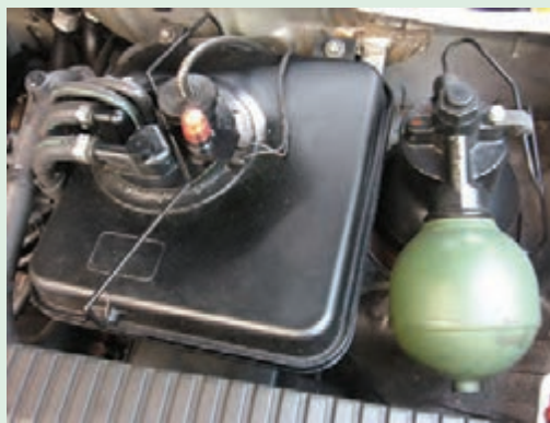
شکل ۳۶- آکومولاتور سیستم تعلیق اتومبیل زانتیا
