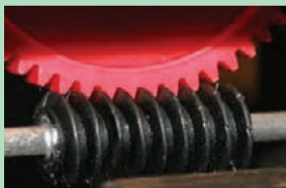
شکل ۵۲- پیچ و چرخ حلزون
