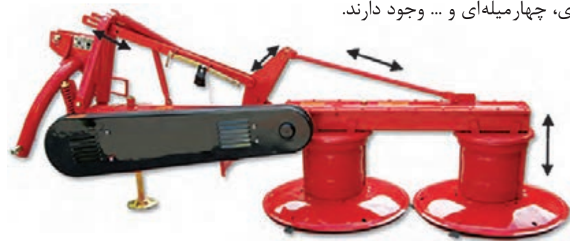
شکل ۴- مکانیزم میله‌ای در دروگر
