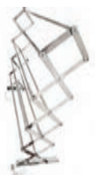
شکل ۶- میله‌ها و مفصل‌های اتصال سه نقطه تراکتور
