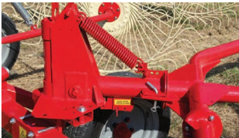
شکل ۱۵- مکانیزم شناوری شانه خورشیدی
