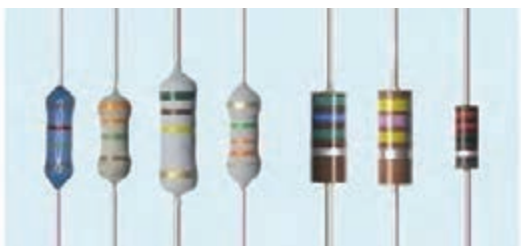
شکل ۲- مقاومت‌های ثابت
