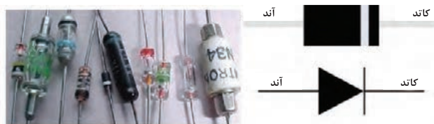
شکل ۹- برخی از انواع دیود
