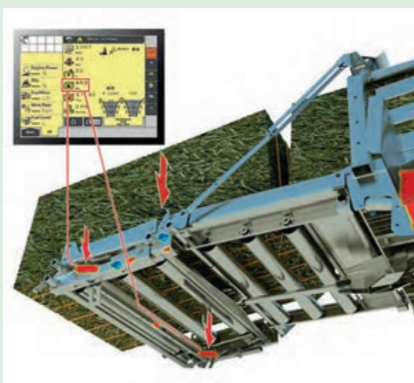
شکل ۴۹- کاربرد لودسل در بسته‌بند مکعبی
