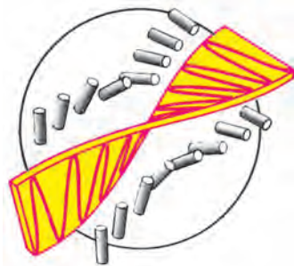
شکل ۵۸-۶- خم شدن مولکول‌های کریستال مایع مطابق جهت تابش نور
