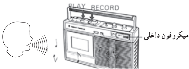
شکل ۴-۲۶ ضبط سیگنال از طریق میکروفون داخلی
