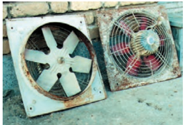
تعویض هواکشهای خراب و فرسوده
