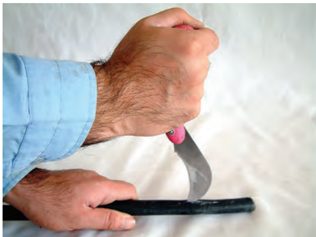
الف - نحوه‌ی غلط لخت کردن کابل
