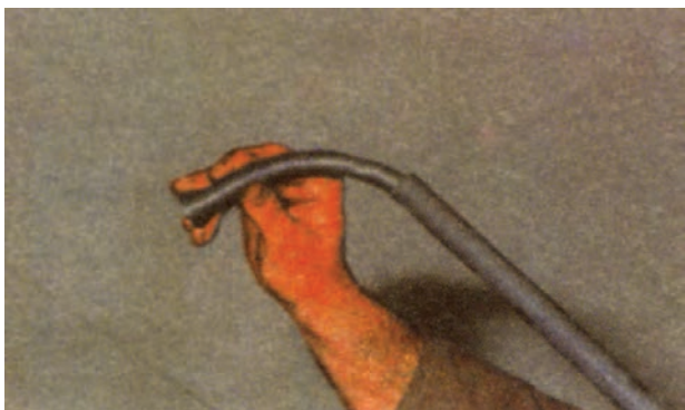
شکل ۴-۴۴- قرار دادن فنر خم‌کاری در داخل لوله
