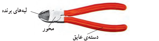
الف - سیم چین معمولی با دسته‌ی عایق
