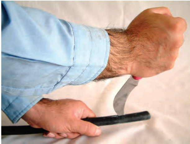
شکل ۳۳-۵- طریقه‌ی صحیح روکش برداری کابل
