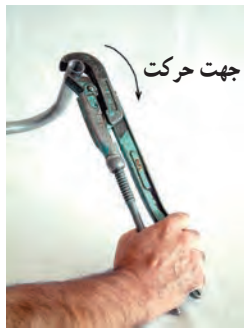
شکل ۹-۴ - طریقه‌ی باز و بسته کردن لوله به وسیله‌ی آچار لوله‌گیر
