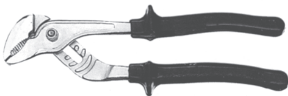
شکل ۱۰-۴ - دو نمونه آچار کلاغی
