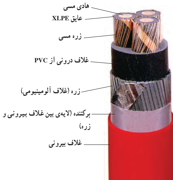
شکل ۵-۷- کابل با غلاف آلومینیومی
