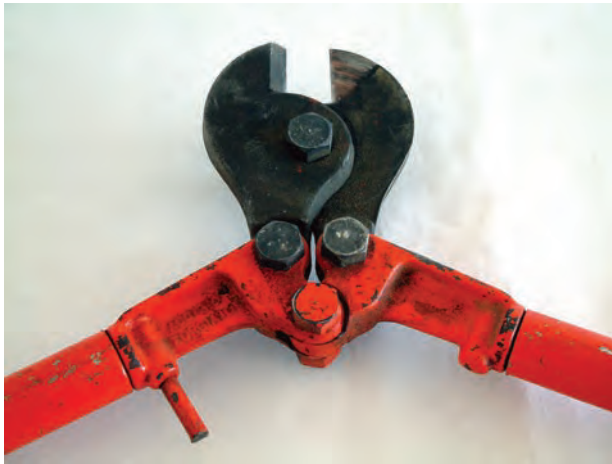
شکل ۵-۷۳- قیچی کابل بری
