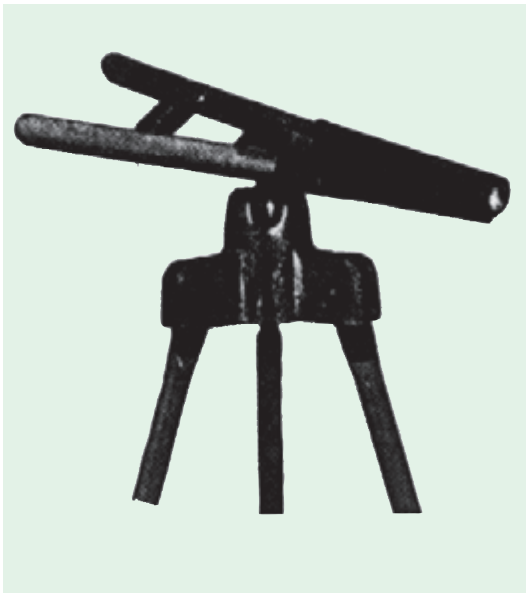
شکل ۳-۳- ژالون گیر و نحوه‌ی به کارگیری آن
