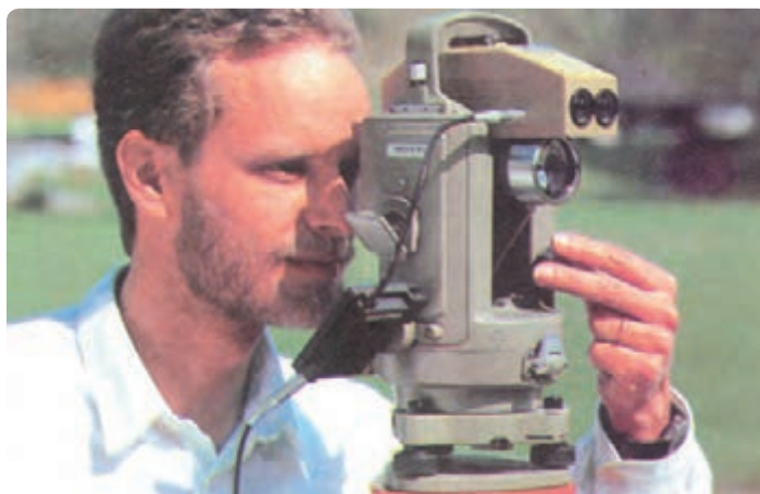
شکل ۲۳-۴ نصب فاصله‌یاب روی دوربین
