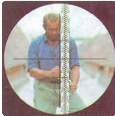
شکل ۱۴-۸- طریقه‌ی نگاه داشتن میر
