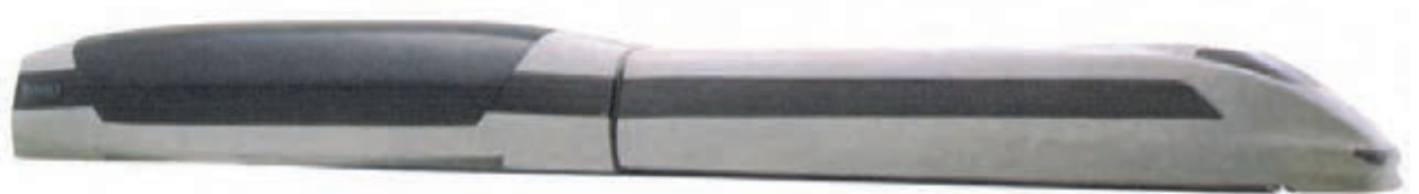
۸- با قرار دادن یک صفحه رنگی، پنجره‌های مدل ساخته شده است.
