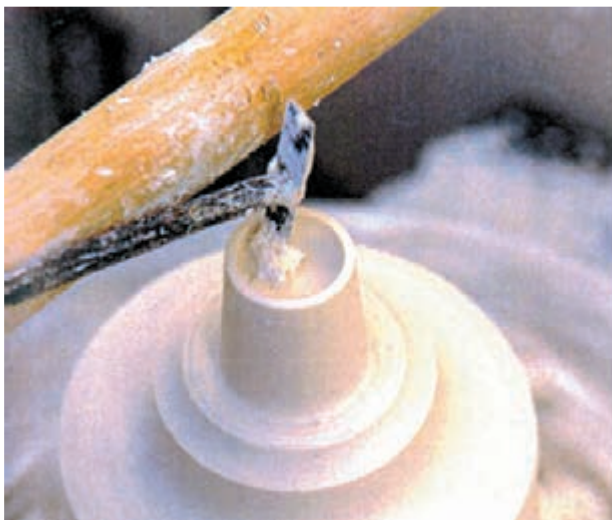
۸- تراش داخلی با استفاده از تکیه‌گاه
