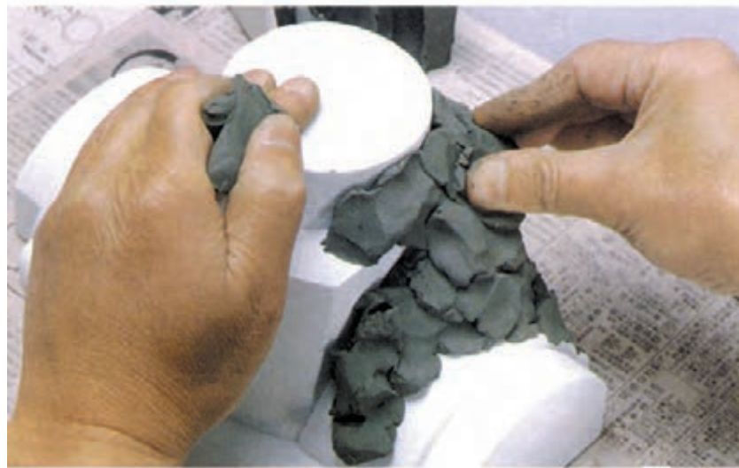
۶- خمیر روغنی (خمیر مجسمه سازی) را با دست به سطح قطعه فشار دهید.
