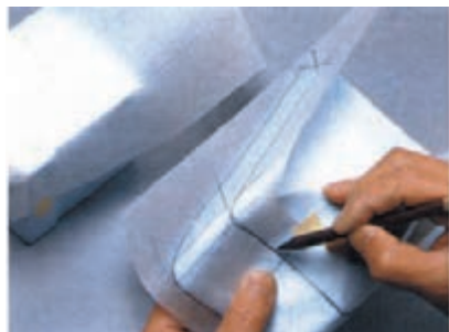
۳- برای به دست آوردن انحنایها، یک کاغذ ترسیم (کالک) روی قسمتهای منحنی شابلون بلوفومی گذارده می شود و خطوط انحنای برای رسم گسترده مدل پلاستیکی ترسیم می گردد.
