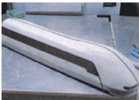
۶- در این تصویر، رخ مدل به وسیله ابزار پرداخت نهایی و کار می‌شود.
