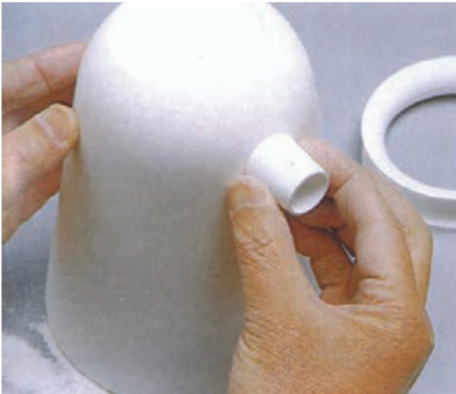
۲۱- نصب قطعات مختلف به وسیله چسب چوب یا لاتکس انجام می گیرد.
