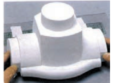
۵- هسته بلوفومی را روی یک صفحه پلاستیکی ثابت کنید.
