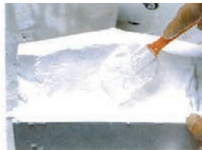
۱۶- گچ را درون قالب یک دست کنید.
