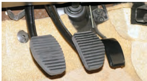
شکل ۱۴۹-۱- روکش نایلونی پدال‌ها
