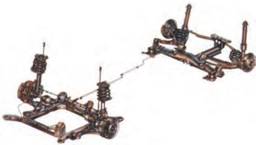
شکل ۳-۴۱- سیستم تعلیق عقب و جلو خودرو
