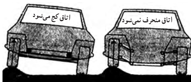
الف- تعلیق مستقل ب- تعلیق یک پارچه
