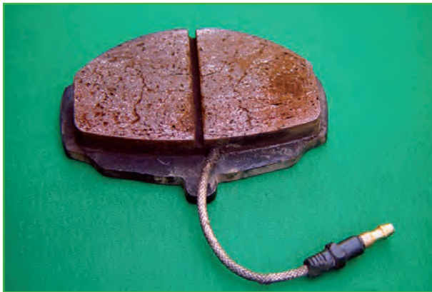
شکل ۱۱۲-۱- لنت ترمز دارای سیم هشدار
