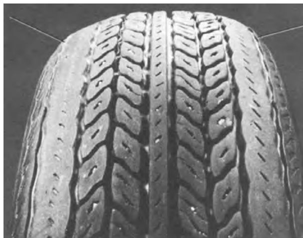
شکل ۲۱۴-۳- سایش در اثر رانندگی غلط (پیچیدن تند)
