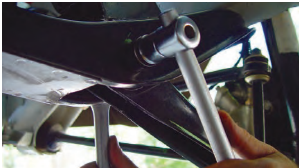
شکل ۳-۸۳- باز کردن طبق از رام
