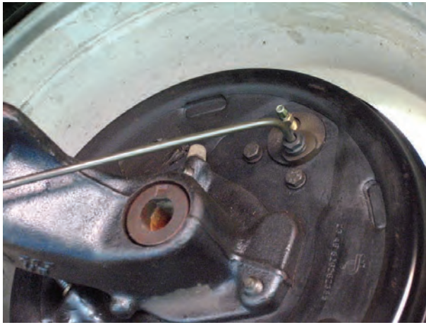
شکل ۱۰۳-۱- پاک کردن اطراف اتصالات
