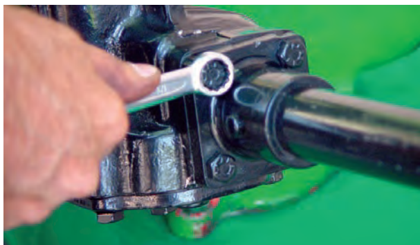
شکل ۲-۶۰- باز کردن پیچ‌های لوله فرمان
