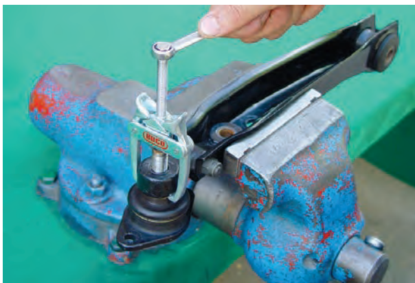
شکل ۳-۸۵- جدا کردن سیبک از بازوی اتصال
