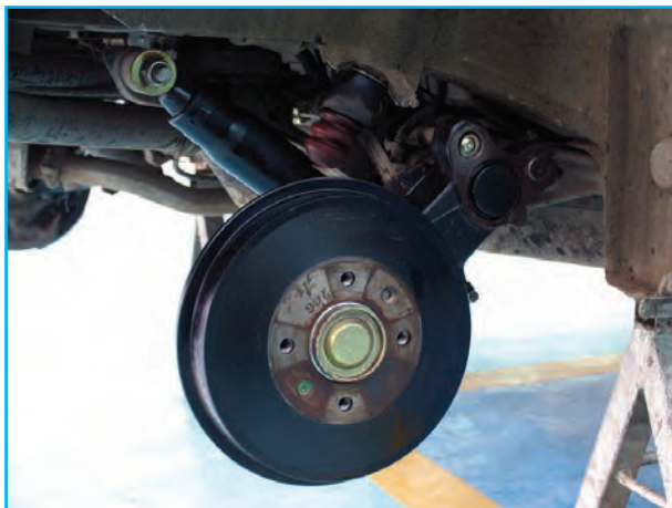
شکل ۱۸۳-۳- نصب ژامبون و متعلقات چرخ عقب
