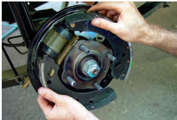
شکل ۱۰۴-۱- خارج کردن کفشک‌ها
