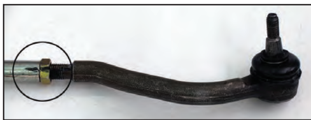
شکل ۲-۷۴- علامت گذاری سبیک و میل رابط
