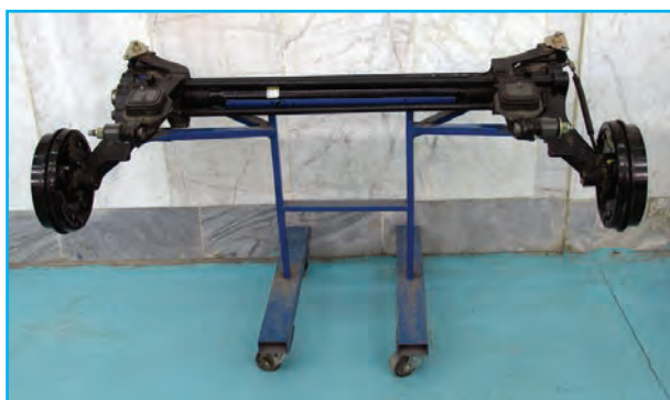
شکل ۱۵۹-۳- مجموعه تعلیق عقب
