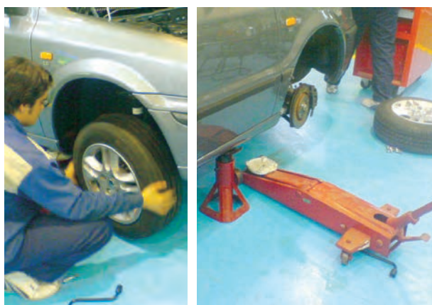
شکل ۱-۱۱۷-۱- بالا بردن و پیاده کردن چرخ جلو
