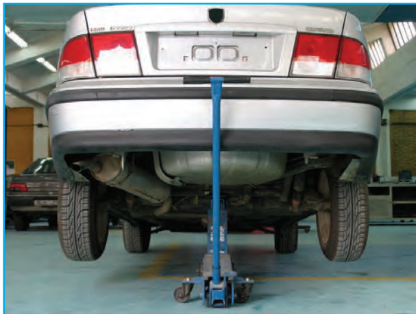
شکل ۳-۱۵۶- تنظیم ارتفاع و کنترل رام لوله‌ای
