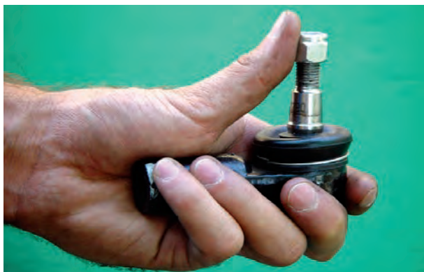
شکل ۸۴-۲- کنترل لقی سیبک‌ها
