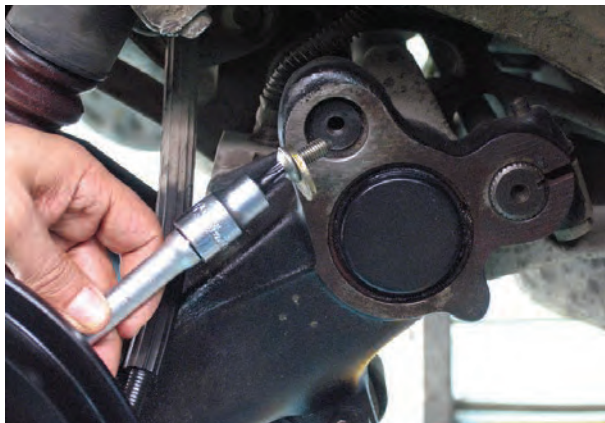
شکل ۱۷۶-۳- نصب واشر فشار و بیج‌های انتهای میله‌ها
