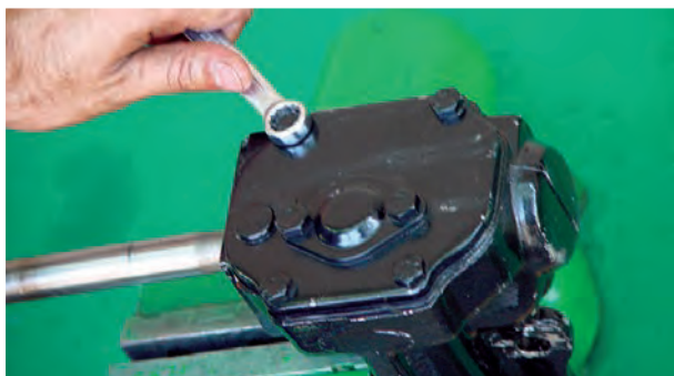
شکل ۲-۶۲- باز کردن درپوش بالایی جعبه فرمان
