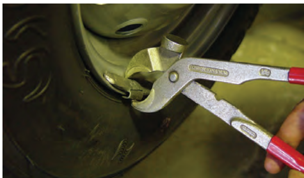
شکل ۲۳۳-۳- تمیز کردن و پیاده کردن سرب‌های قبلی
