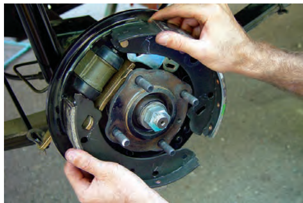
شکل ۹۳-۱- خارج کردن کفشک‌ها
