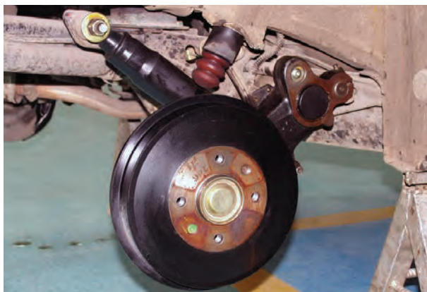
شکل ۱۷۷-۳- نصب کمک فنر
