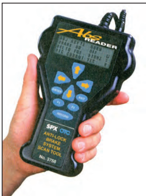
شکل ۱۶۵-۱- نوعی عیب‌یاب پرتابل
