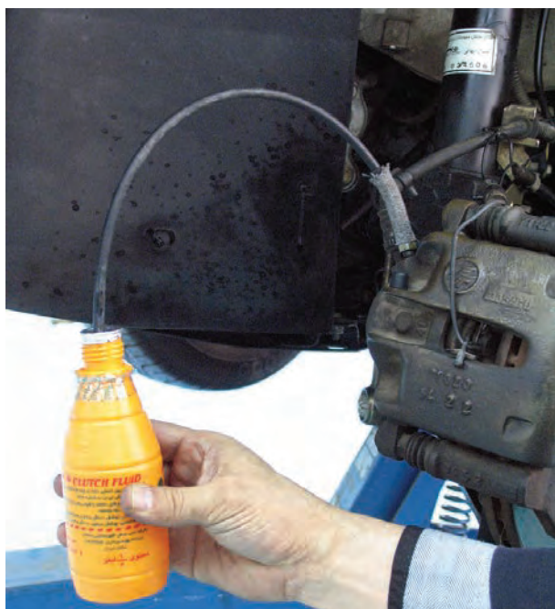
شکل ۱-۷۱- نصب لوله پلاستیکی روی پیچ هواگیری
