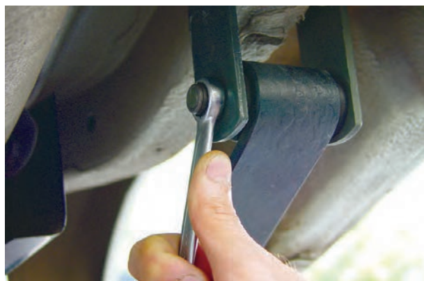
شکل ۳-۶۵- باز کردن مهره‌های گوشواره فنر شمش
