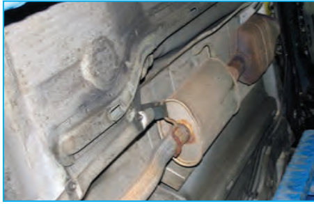
شکل ۱-۵۱- سپر حرارتی آگزوز
