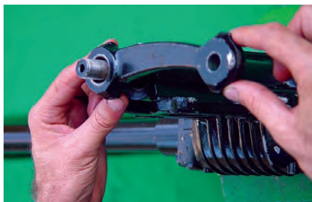
شکل ۲-۵۹- پیاده کردن اهرم هزار خار
