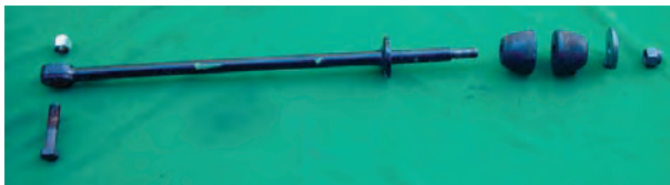
شکل ۳-۸۴- اجزای میل تعادل
