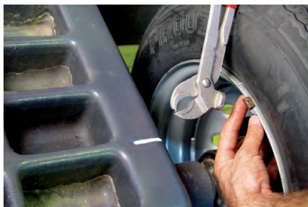
شکل ۲۳۹-۳- نصب وزنه روی قسمت داخلی رینگ
