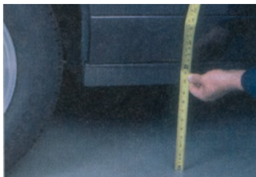
شکل ۳-۲۰۱- ارتفاع سیستم تعلیق (خودرو)
