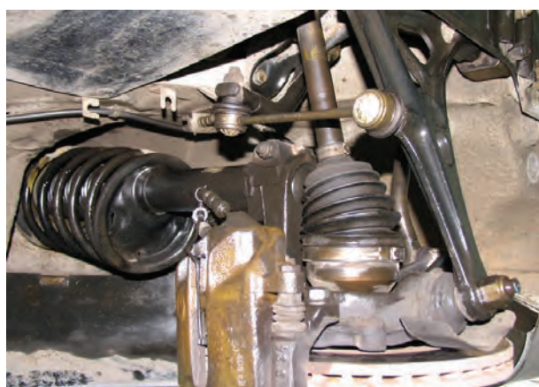
شکل ۱۳۱-۳- نصب میل موج گیر کوتاه
