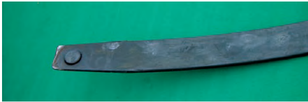
شکل ۷۰-۳- لاستیک‌های محافظ انتهایی لایه‌های فنر شمش
