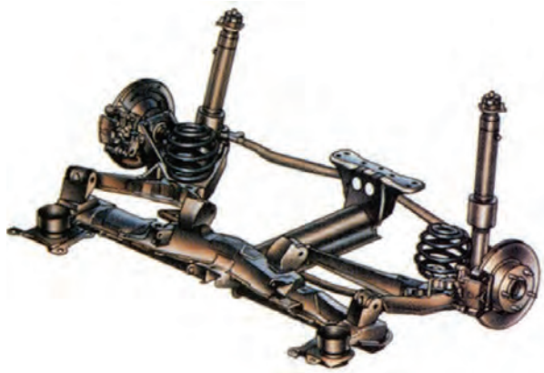
شکل ۳-۴۸- سیستم تعلیق مستقل عقب با چرخ‌های متحرک
