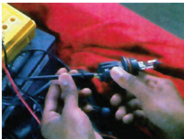
شکل ۱۴۲-۱- آزمایش لامپ چراغ‌های بزرگ جلو
