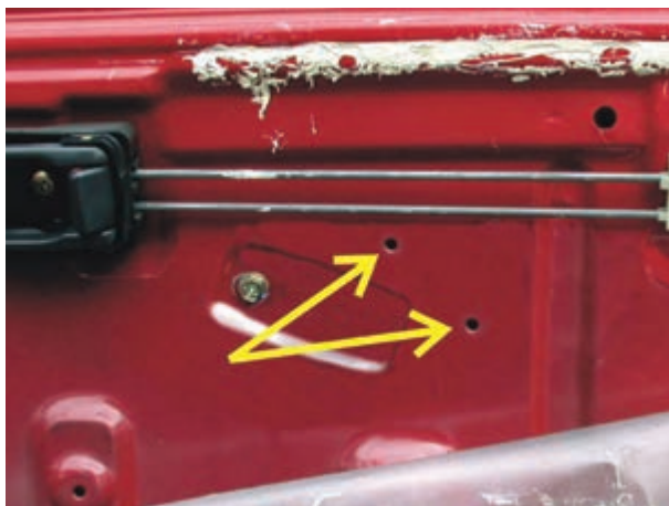
شکل ۲-۲۷ سوراخ کاری بدنه‌ی داخلی در خودرو
