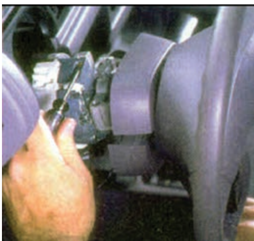
شکل ۱-۹۵- باز کردن پیچ بدنه سوئیچ روشنایی
