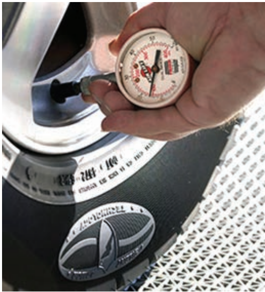
شکل ۱۵۸-۱- کنترل فشار باد تایر
