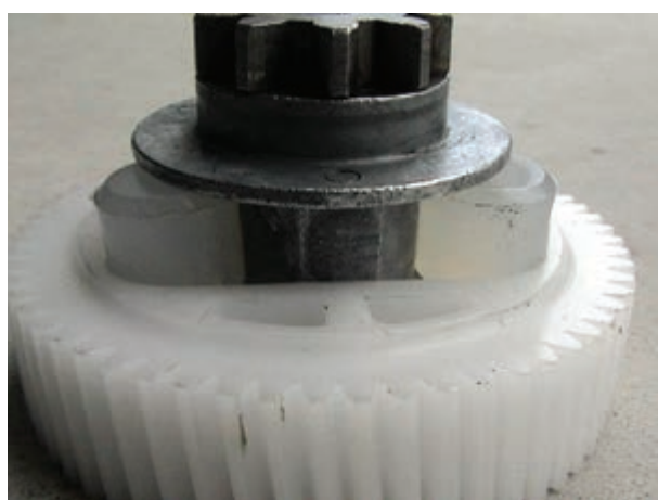
شکل ۱۲۸-۲ سوار کردن چرخ دنده‌ی فلزی
