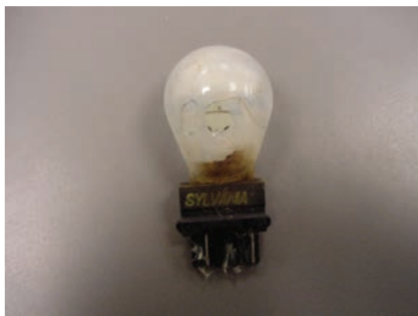
شکل ۱۴۱-۱- اثر عوامل فیزیکی در معیوب شدن لامپ
