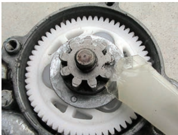
شکل ۱۳۰-۲- روغن کاری چرخ دنده‌ها
