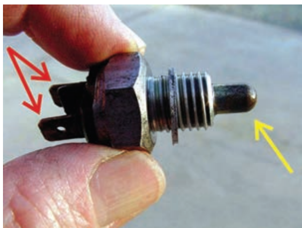
شکل ۱۰۴- پلانجر و ترمینال‌های سوئیچ دنده عقب
