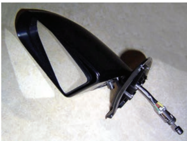
شکل ۱۵۶-۲- آینه‌ی جانبی و مکانیزم حرکت آن
