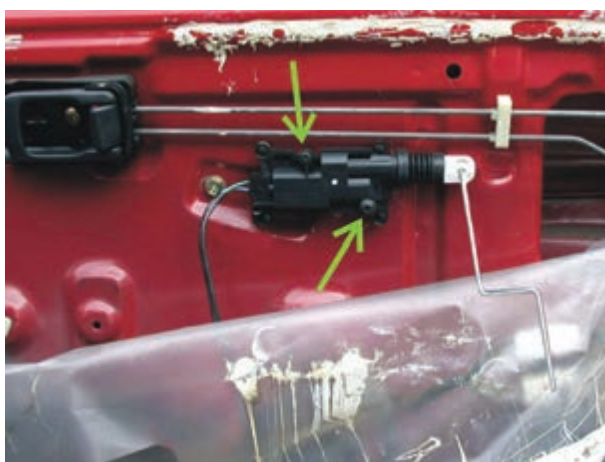
شکل ۲-۲۹ اتصال عملگر الکتریکی در روی در خودرو
