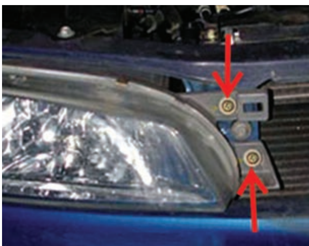
شکل ۱-۴۰- پیچ‌های نگه‌دارنده‌ی چراغ‌های بزرگ جلو
