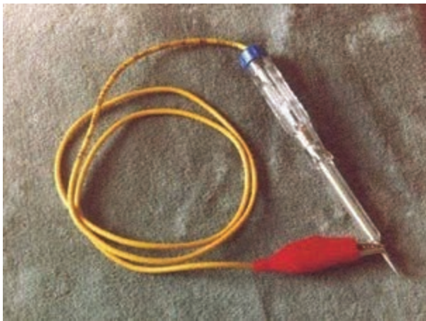
شکل ۱-۱۲۱- چراغ آزمایش بدون باتری
