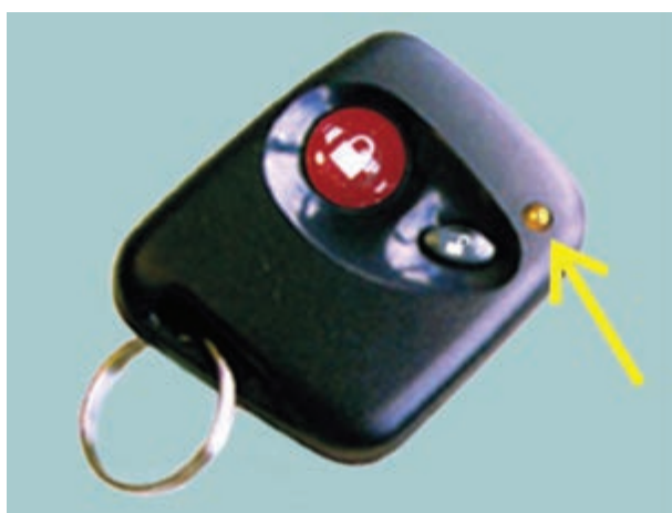
شکل ۲-۷- دیود نوری روی قاب ریموت کنترل
