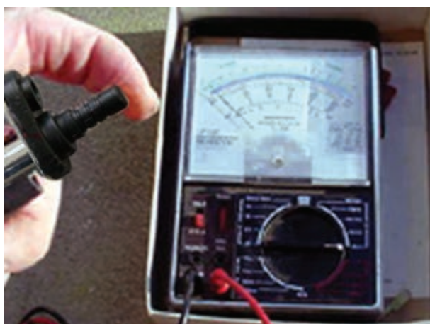
شکل ۱۹۶-۱- آزمایش سوئیچ لای در
