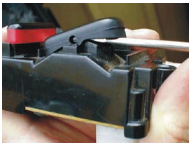
شکل ۲-۱۴۵- تعویض شستی معیوب
