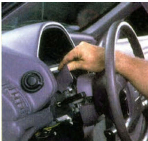
شکل ۹۱-۱- بیرون آوردن قاب سوئیچ روشنایی
