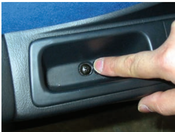
شکل ۱۸۲-۲- پیچ اتصال قاب سوئیچ به بدنه
