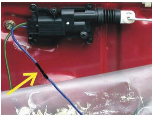
شکل ۲-۴۹- عایق کاری محل اتصال سیم‌ها به یکدیگر
