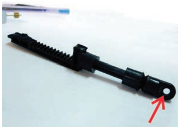
شکل ۱۸-۲- شانه‌ی دندانه‌دار دو قسمتی (محور عملگر)
