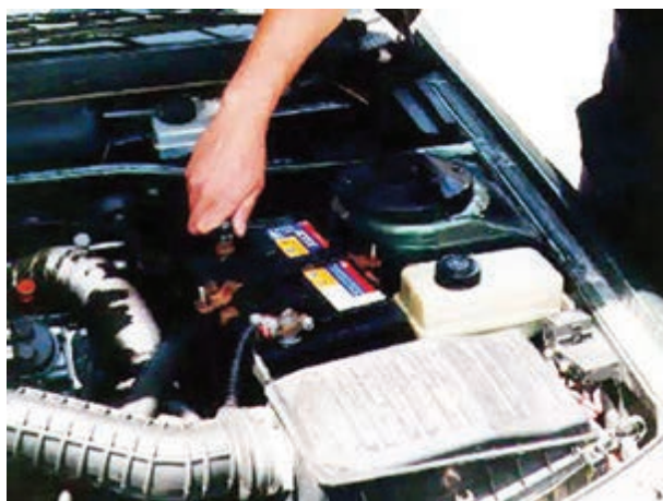
شکل ۱۶۴-۲ بازکردن کابل اتصال بدنه‌ی باتری
