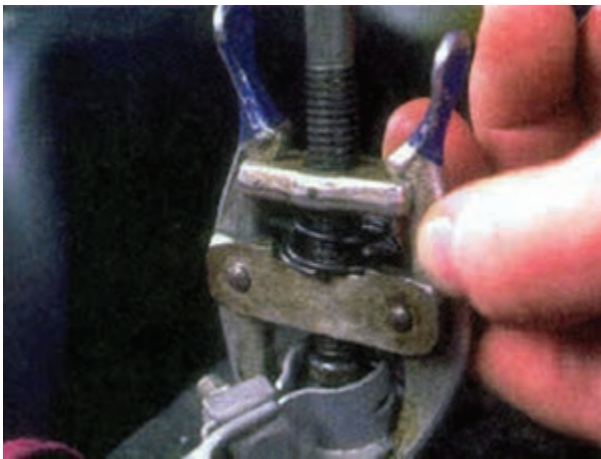
شکل ۱-۸۹- باز کردن بست اتصال بدنه‌ی باتری
