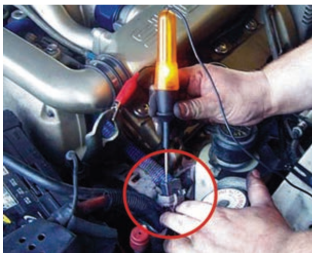
شکل ۱۴۵-۱- آزمایش برقراری جریان مدار چراغ های روشنایی
