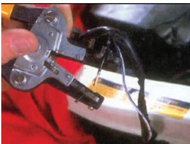
شکل ۱۴۷-۱- استفاده از ابزار سیم لخت کن
