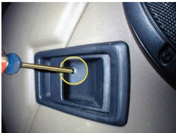
شکل ۳۶-۲- باز کردن قاب دستگیره‌ی قفل در
