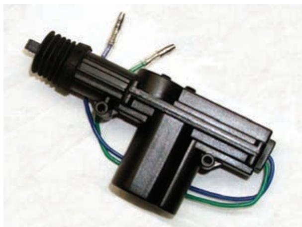
شکل ۲۵-۲- عملگر الکتریکی دو سیمی
