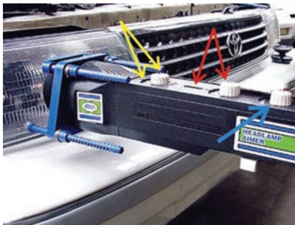
شکل ۱۶۱-۱- پیچ‌های تنظیم دستگاه تنظیم نور چراغ‌ها
