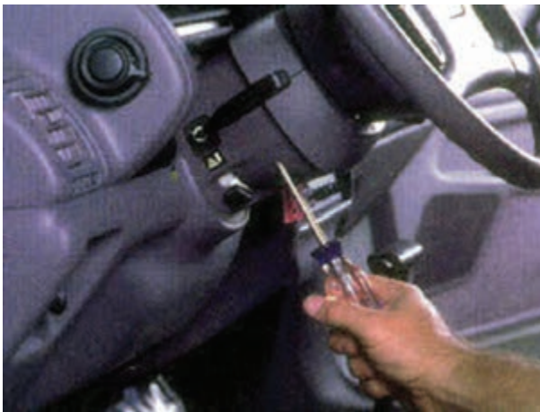
شکل ۱-۹۰- باز کردن پیچ‌های قاب سوئیچ روشنایی
