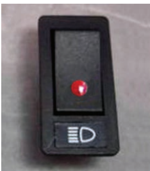
شکل ۸۱-۱- سوئیچ چراغ‌های جانبی (پارک)
