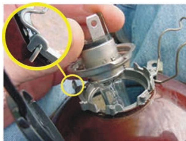
شکل ۱-۴۳- نحوه‌ی ثابت شدن لامپ درون کاسه‌ی چراغ
