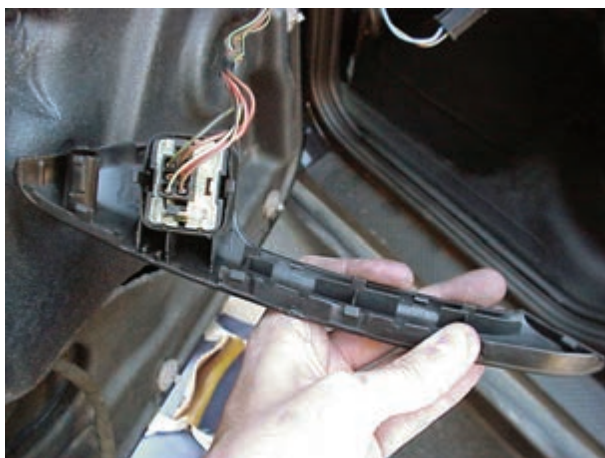
شکل ۱۱۸-۲- اتصال سوکت سوئیچ شیشه بالابر
