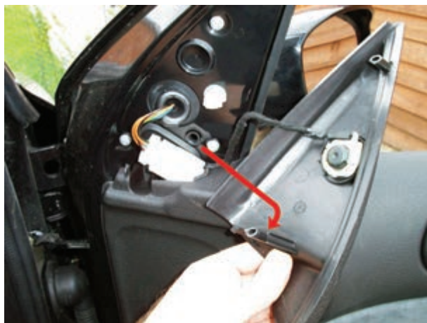
شکل ۱۶۵-۲ خارهای روی قاب و محل نصب آن
