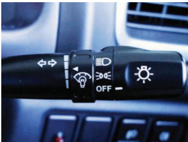
شکل ۱-۷۲- سوئیچ چراغ‌های روشنایی (طرح دسته‌ی راهنما)
