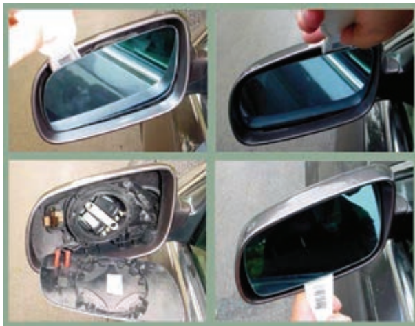
شکل ۱۶۷-۲- بیرون آوردن آینه از داخل قاب آن
