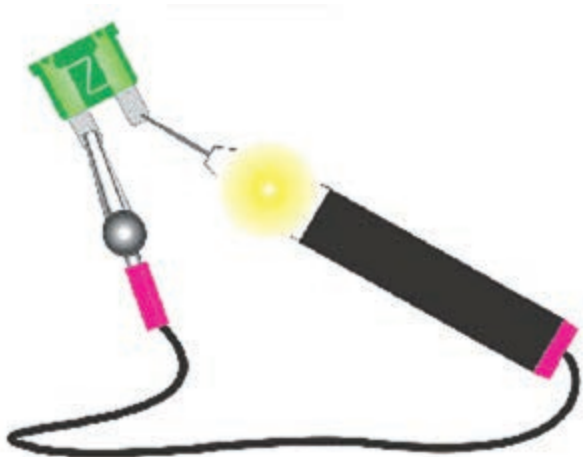
شکل ۱۱۶-۱- آزمایش فیوز تیغه‌ای با استفاده از چراغ آزمایش
