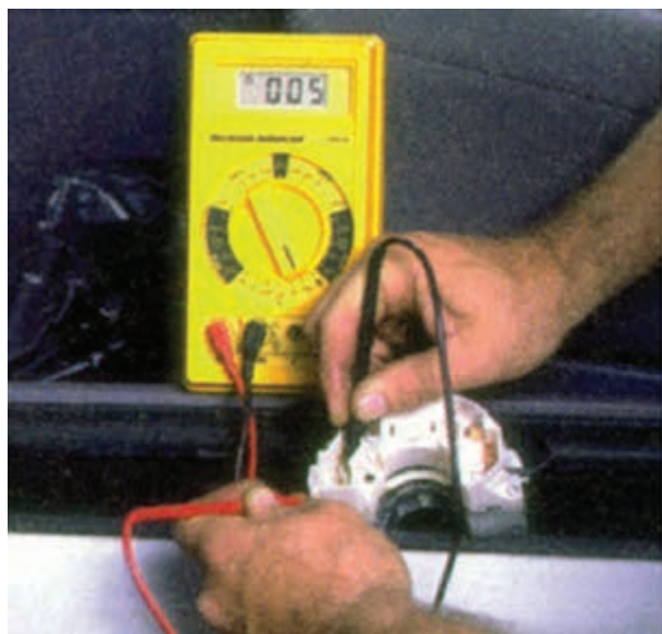
شکل ۹۷-۱- آزمایش سوئیچ روشنایی
