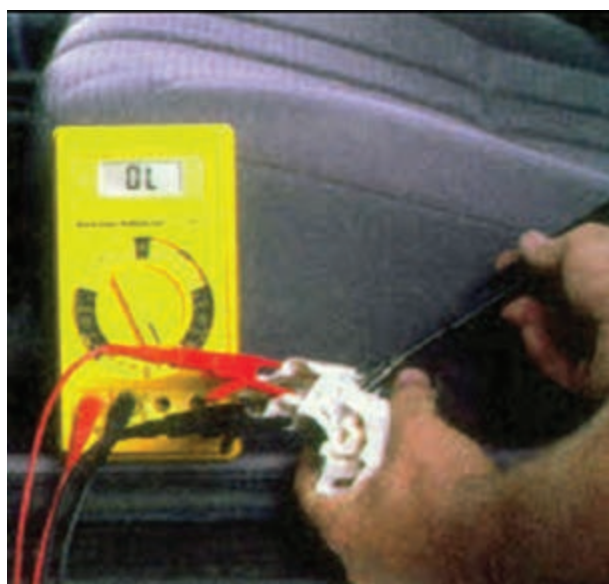
شکل ۹۸-۱- آزمایش حالت استپ موقت دسته ی راهنما
