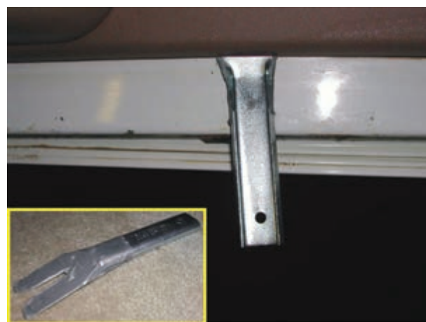
شکل ۲-۳۵- اهرم خاردرآر و نحوه‌ی استفاده از آن
