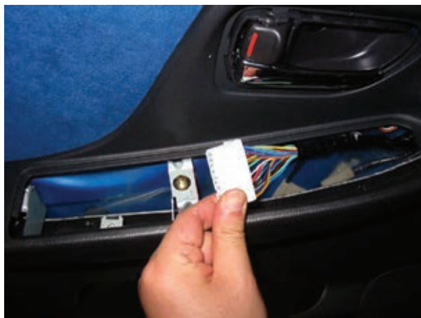
شکل ۱۸۵-۲- سوکت اتصال دسته سیم به سوئیچ‌ها
