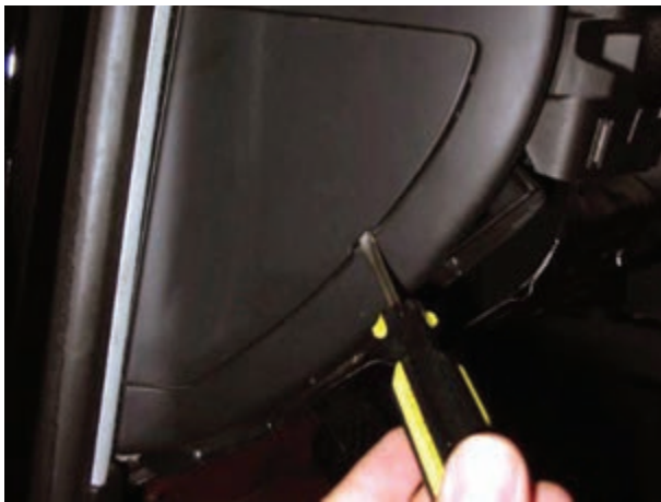
شکل ۱۱۸-۱- آزاد کردن خار پوشش محافظه‌ی جعبه‌ی فیوز
