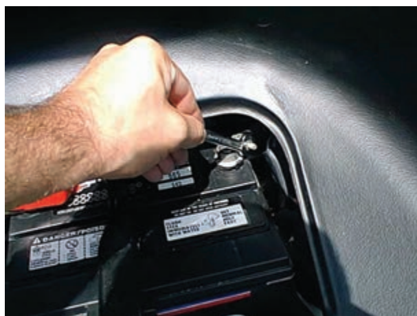
شکل ۱-۵۲ باز کردن بست ترمینال منفی باتری
