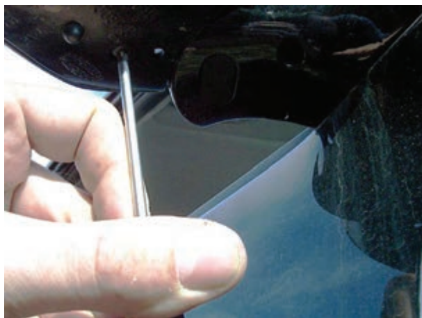
شکل ۱۷۵-۲- بازکردن پیچ پایین قاب بیرونی آینه
