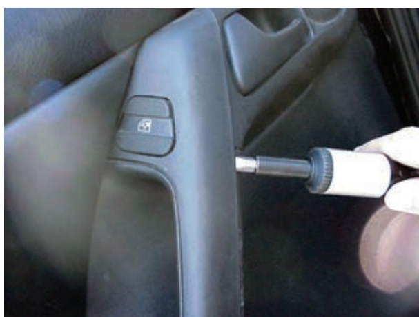
شکل ۲-۱۱۰- جدا کردن قاب سوئیچ شیشه بالابر
