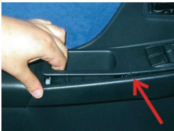
شکل ۱۸۳-۲- خارج نمودن قاب سوئیچ‌ها
