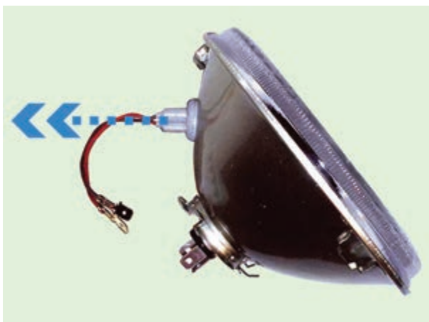
شکل ۱-۴۸ - جهت اعمال نیرو به قاب لامپ پارک برای خارج نمودن آن از داخل کاسه‌ی چراغ
