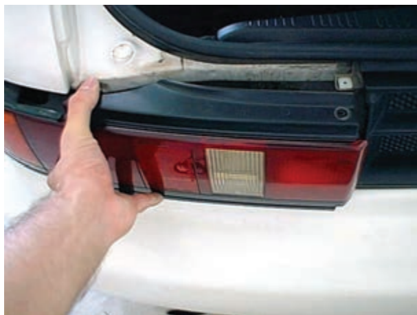
شکل ۱-۵۸- جدا کردن چراغ عقب از بدنه‌ی خودرو
