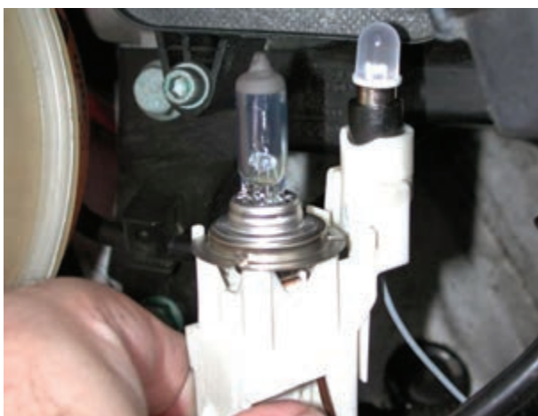
شکل ۱-۴۹ - پایه‌ی مشترک لامپ‌های چراغ روشنایی و پارک
