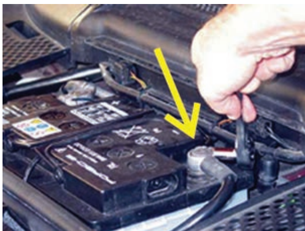
شکل ۱۴۱-۲- باز کردن کابل اتصال بدنه‌ی باتری
