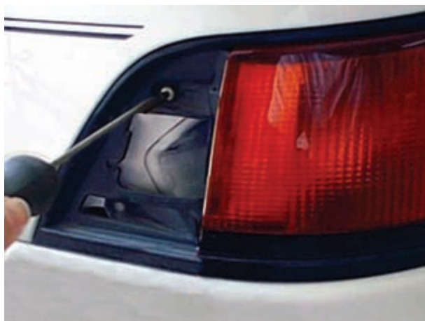
شکل ۱-۵۶- باز کردن پیچ‌های قاب چراغ
