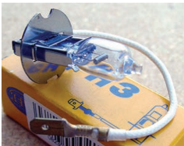
شکل ۱-۳۱- لامپ مورد استفاده در چراغ‌های مه‌شکن، نورافکن‌ها
