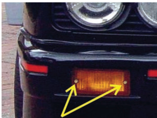
شکل ۱-۵۰ پیچ‌های اتصال تلق چراغ راهنما
