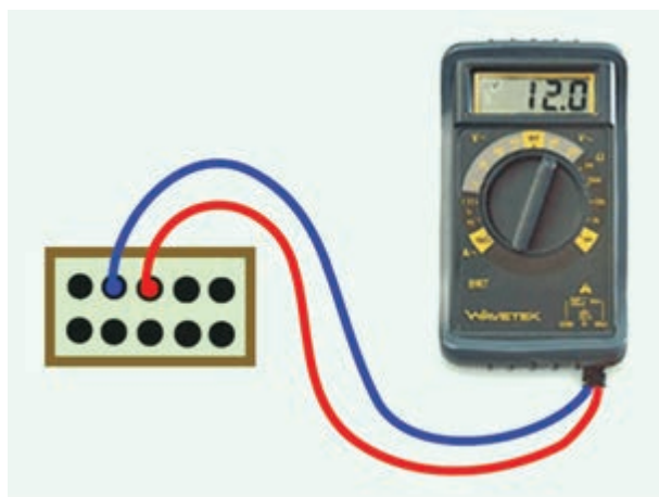
شکل ۱۹۰-۲- اندازه گیری ولتاژ باتری در ترمینال سوکت اتصال الکتریکی
