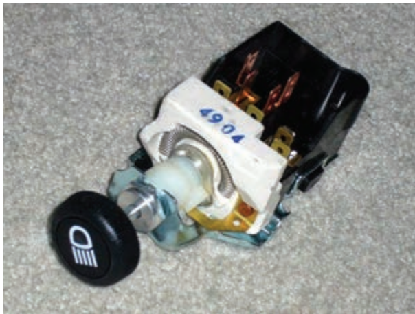
شکل ۱-۷۱- سوئیچ چراغ‌های روشنایی نوع چرخشی
