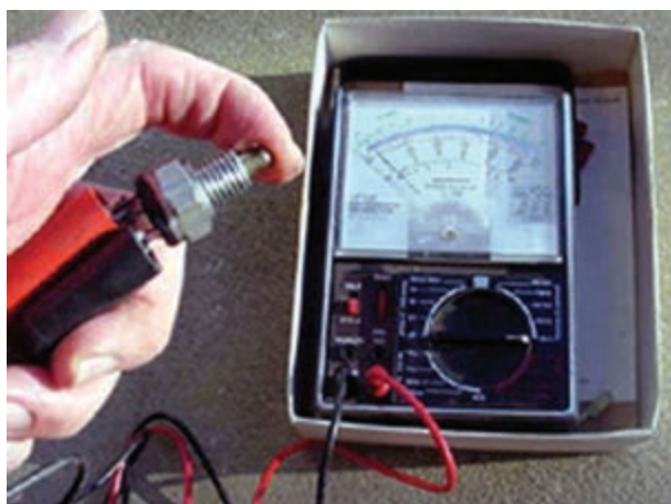
شکل ۱۰۵-۱- آزمایش سوئیچ چراغ‌های دنده عقب
