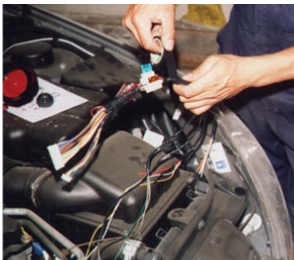
شکل ۲-۷۷- نحوه‌ی عایق‌بندی سیم‌های مدار الکتریکی دزدگیر
