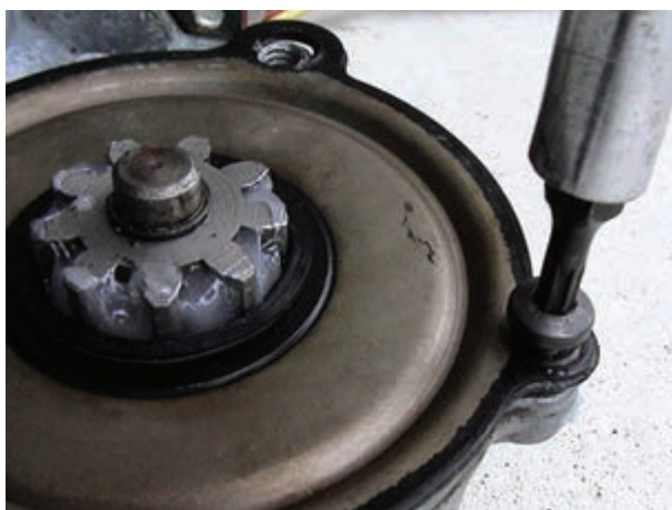
شکل ۱۳۱-۲- بستن پیچ‌های درپوش به بدنه
