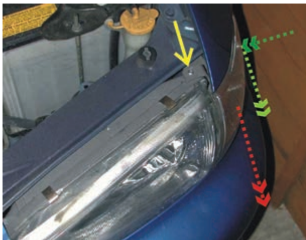
شکل ۱-۳۸- نحوه‌ی جداکردن چراغ جانبی روشنایی
