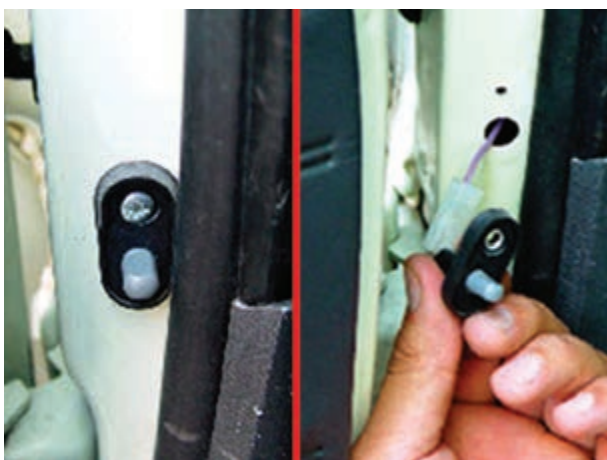
شکل ۱۹۲-۱- باز کردن سوئیچ لای در
