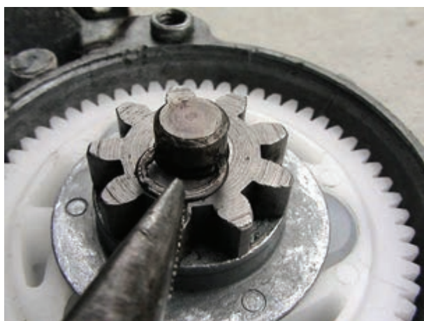
شکل ۱۲۹-۲ جانداختن خار فنری
