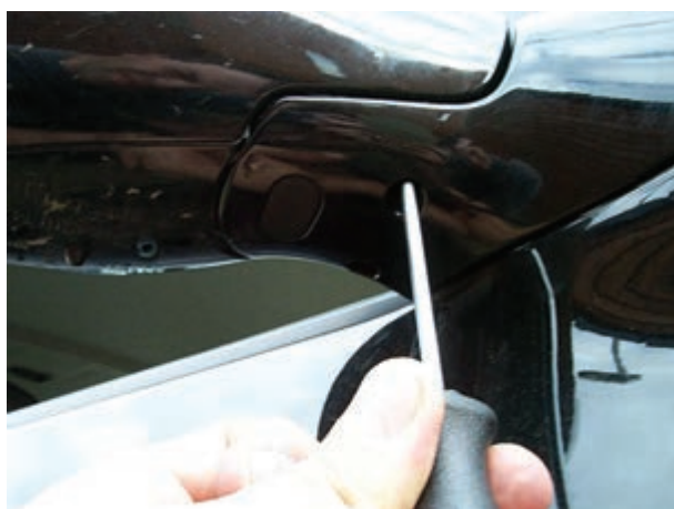
شکل ۱۷۶-۲- بازکردن پیچ روی پایه ی بیرونی آینه
