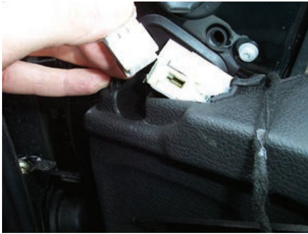
شکل ۱۶۶-۲- جدا کردن سوکت سیم کشی آینه
