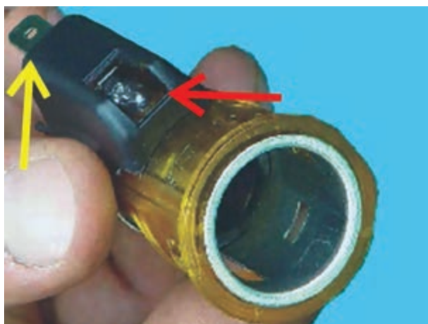
شکل ۱-۲۲۴- لامپ فندک و ترمینال الکتریکی آن
