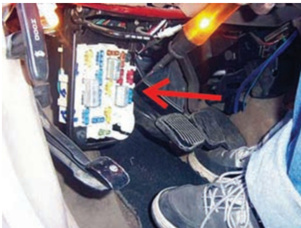
شکل ۱۲۰-۱- آزمایش جعبه‌ی فیوز با چراغ آزمایش
