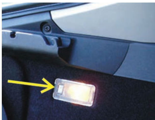
شکل ۲۱۸-۱- چراغ صندوق عقب و سوئیچ روی آن
