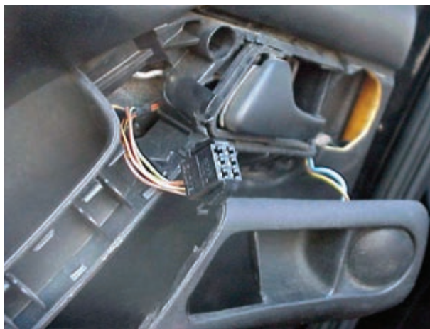
شکل ۱۱۲-۲- جدا کردن قاب روی اهرم قفل دستی در
