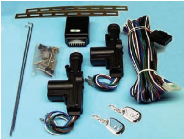
شکل ۱-۲- اجزای مدار قفل مرکزی
