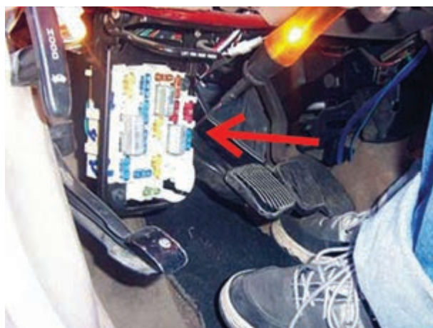
شکل ۱۸۹-۲- آزمایش پایه‌های فیوز
