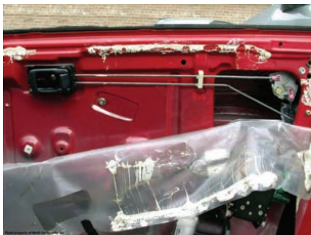
شکل ۲۶-۲- جدا کردن پلاستیک محافظ روی در
