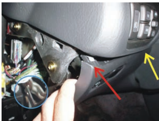
شکل ۱-۸۵- خارج کردن قاب از روی بدنه‌ی پانل
