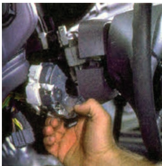
شکل ۱-۹۶- خارج کردن سوئیچ روشنایی از محل خود
