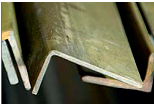
شکل ۲-۳۶ نبشی دو بال نامساوی
