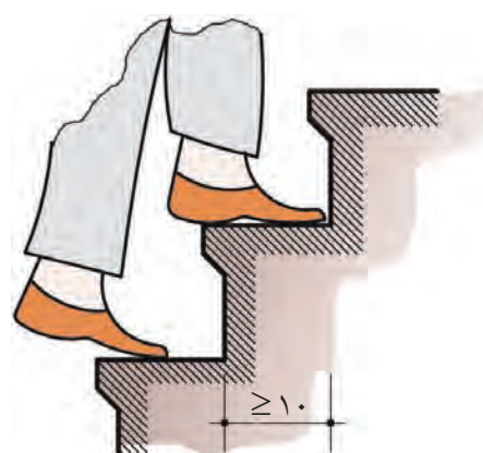
شکل ۱۶-۳ کوچک‌ترین اندازه‌ی کف پله در پله‌های پیچ
