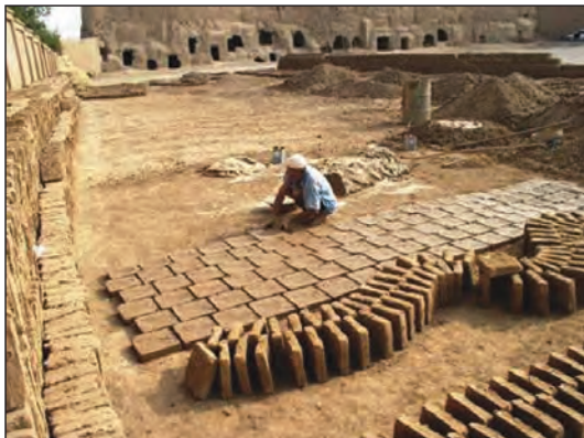
شکل ۱-۵۴ خشت خام (ساخت آجر به روش دستی)
