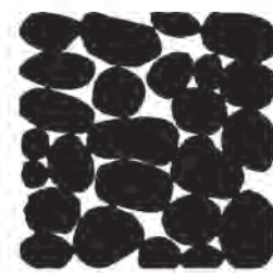
بتن خشن با دانه بندی درشت و متخلخل
