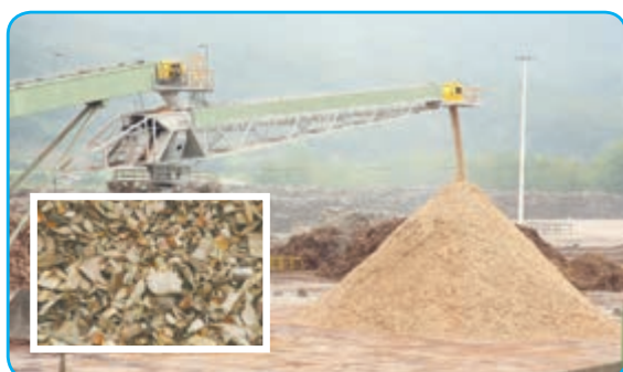
۴ تبدیل به تکه‌های ریز چوب (چیپس چوب)
