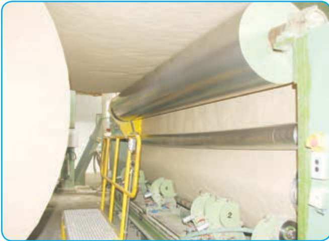
غلتک آهنی برای صاف کردن خمیر کاغذ
