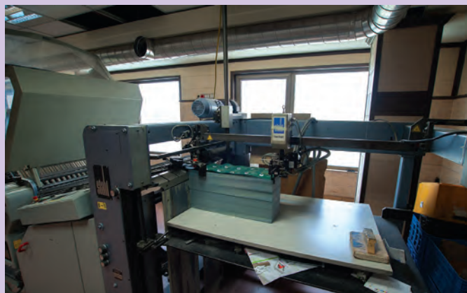
تصویر ۱۷ محصول چایی پس از برش در دستگاه «تا» قرار داده می شود
