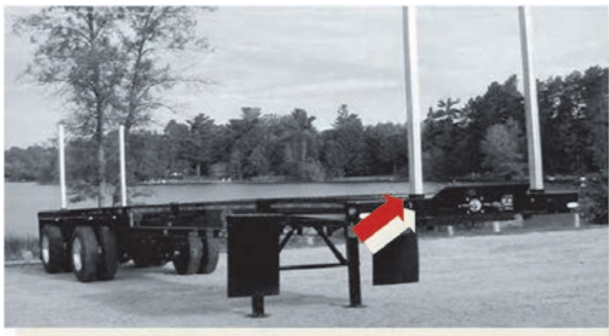
شکل ۴۴- تیرک‌های قائم و نحوه قرارگیری آنها در کنار بارگیر
