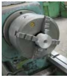
ب: بستن قطعه گرد در چهار نظام
