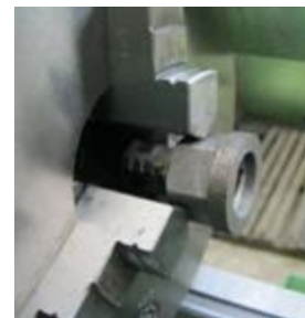
الف: بستن قطعه شش گوش در سه‌نظام
