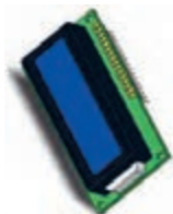
LCD کاراکتری برای نمایش اطلاعاتی مانند فاصله
