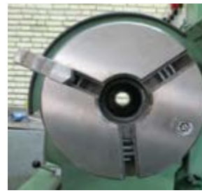
الف: استقرار فک روی پیچ ارشمیدس
