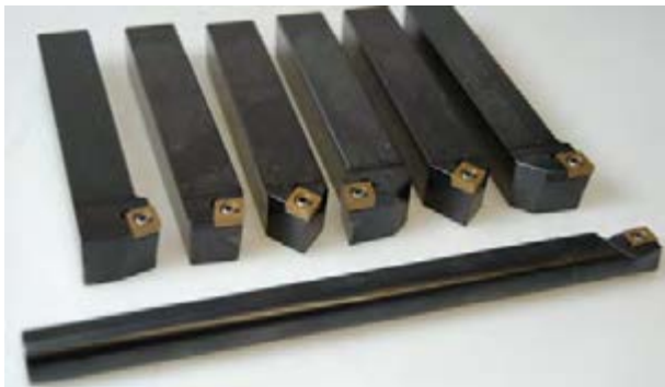
شکل ۲-۲۰: تیغچه بسته شده در نگه دارنده (هولدر)
