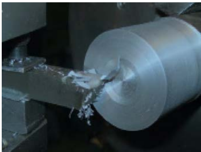
شکل ۲-۲۹: تراشکاری قطعات کوتاه
