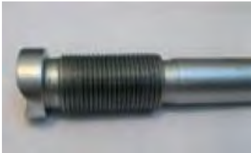
شکل ۲-۳۴: نمونه کار شیار تراشی
