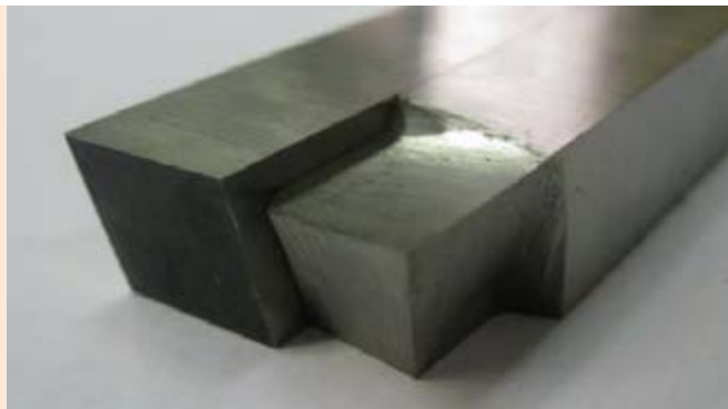
شکل ۲-۲۱: رنده قبل و بعد تیز کردن
