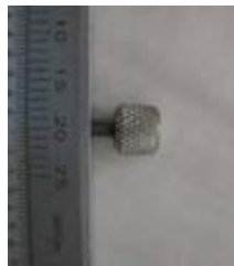
شکل ۲-۴۱: نمونه کار آج‌زنی
