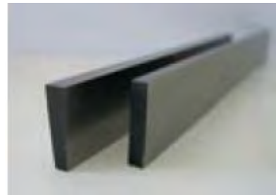
شکل ۲-۳۵: رنده شیار تراشی
