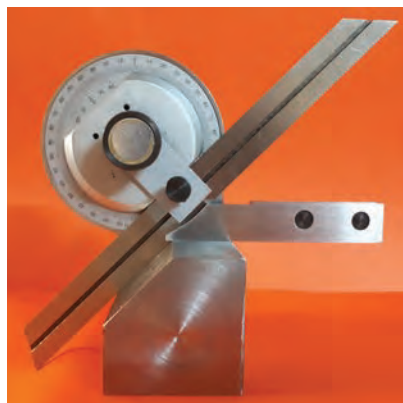
شکل ۴۴- کنترل زاویه قطعه شماره ۲ با زاویه سنج ۵ دقیقه
