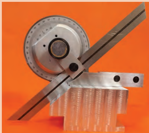
شکل ۱۴- اندازه گیری زاویه باز قطعه کار
