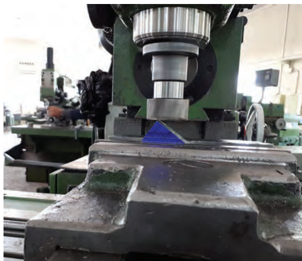
شکل ۱۸- خط کشی و بستن قطعه در گیره
