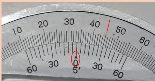
شکل ۱۲- اندازه تنظیمی با زاویه‌سنج
