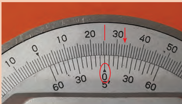
شکل ۱۱- اندازه‌گیری با زاویه‌سنج
