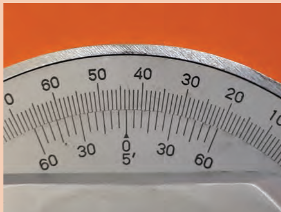
شکل ۱۴- اندازه گیری زاویه باز قطعه کار
