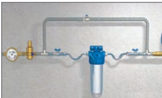
شکل ۶ - روش نصب سختی گیر پلی فسفات
