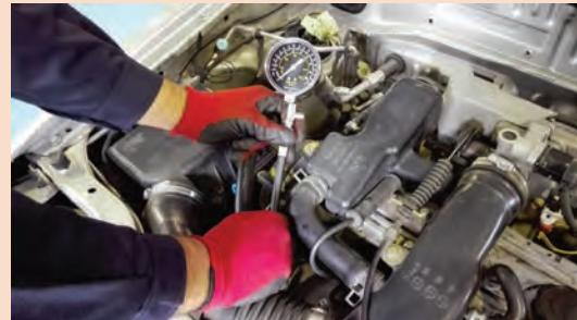
۳ دستگاه کمپرس سنج جایگزین شمع سیلندر شود.
