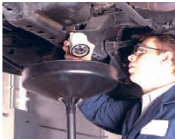
۲ برای جلوگیری از پخش روغن در محیط، زیر آن قیف یا ظرف مناسب جمع آوری روغن کار کرده قرار داده شود.
