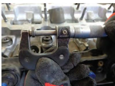
۳ شیم هر سوپاپ اندازه‌گیری شود.
