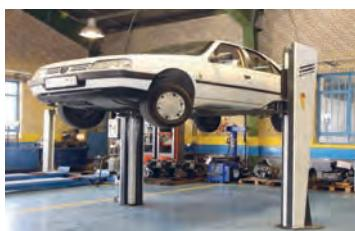
۴ پس از رسیدن موتور به دمای کاری، آن را با رعایت ایمنی روی چاله سرویس و یا جک بالابر قرار دهید.
