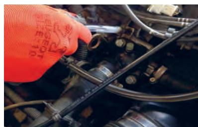
۱ روی پیچ هواگیری لوله شفافی بسته، سپس پیچ هواگیری شل شود.
