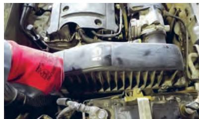
۴ در پوش محفظه هوکش و پیچ‌های آن بسته شود.
