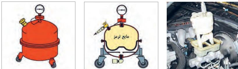
شکل ۱۴-۶- تعویض و هوایگیری سیستم هیدرولیک ترمز با دستگاه تزریق تحت فشار
