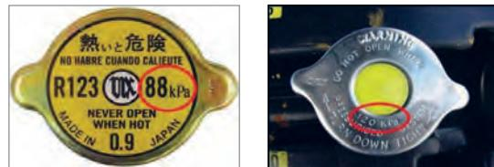
شکل ۷-۲۵- محل نوشته شدن فشار کارکرد روی در چند رادیاتور
