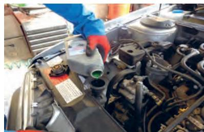
۲ مایع خنک کننده به آرامی از راه دهانه رادیاتور یا مخزن انبساط، اضافه شود.
