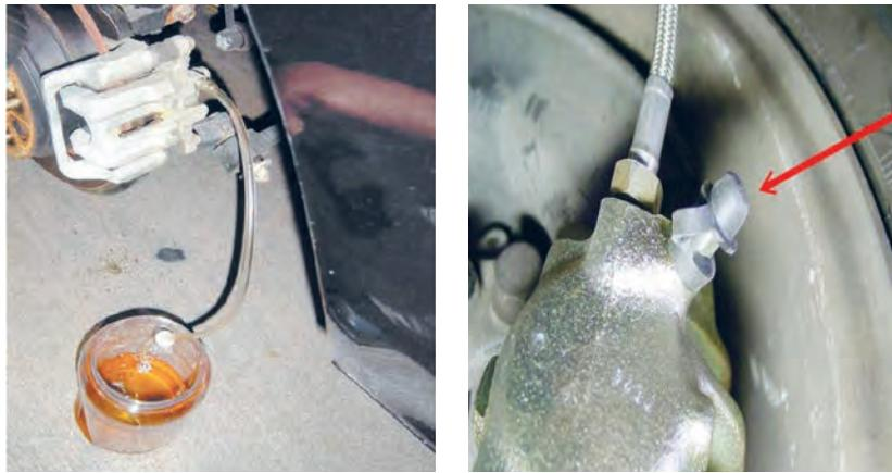
شکل ۱۰-۶- تعویض مایع هیدرولیک ترمز به روش دستی و بدون دستگاه خلاً
