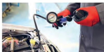
۲ با کمک تلمبه دستگاه، فشار مدار به نزدیک مقدار مجاز افزایش می‌یابد. افت فشار نشان‌دهنده نشتی است.
