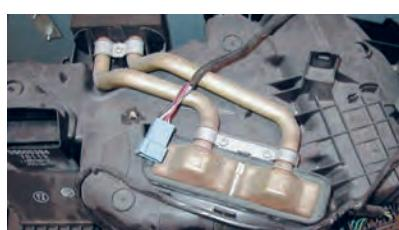
۶ شیلنگ‌های رابط و بسته‌های بخاری بررسی شود.
