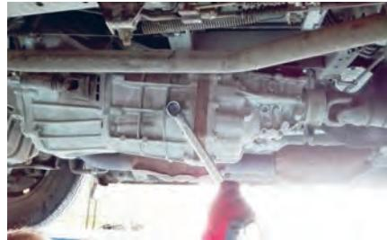
شکل ۴-۵-روش بررسی سطح و رنگ روغن
