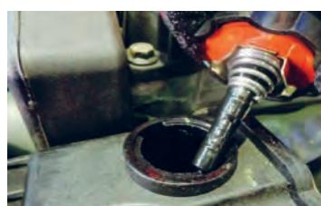
۵ دستگاه وکیوم از مخزن جدا شود و سطح مایع مخزن بررسی شده، در صورت لزوم به آن اضافه شود.
