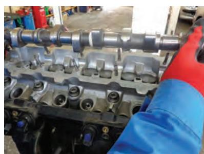
۴ میل سوپاپ باز شود.
