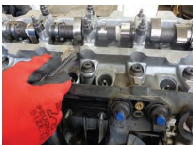
۱ فیلر سوپاپ‌ها برپایه دستور کار کتاب راهنمای تعمیرات اندازه‌گیری و یادداشت شود.
