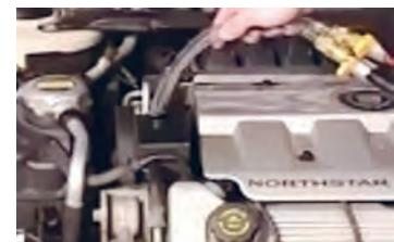
۶ با توجه به رویه بهره برداری از دستگاه، لوله مکش ساکشن در محل گفته شده، قرار داده شود و فرایند تعویض کامل با دستگاه اجرا شود.
