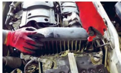
۱ مانند کتاب راهنمای سرویس و تعمیرات، بسته‌ها و پیچ‌های در پوش فیلتر هوا باز شود.
