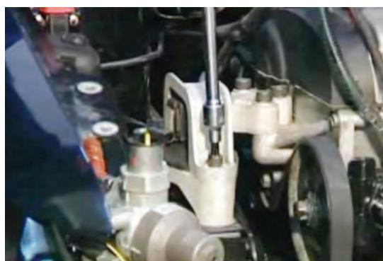
۱ موتور با بستن زنجیر جک موتور باز شود و موتور خارج شود.
