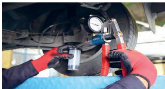
شکل ۶-۱۲- نمونه‌ای از دستگاه خلأیی هواگیری سیستم ترمز
