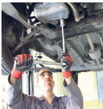
۲ پیچ تخلیه کارتر با گشتاور مناسب بسته شود.
