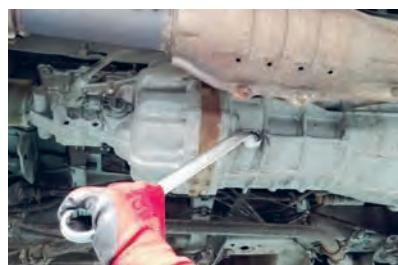
۱ پیچ تخلیه روغن بسته شود.
