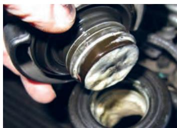
۶ گلوبی رادیاتور یا مخزن انبساط از نظر چرب بودن یا وجود رسوب بررسی شود.
