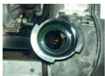
۷ در صورت چرب بودن سطح مایع، وجود زنگ زنگی روی سطح مایع یا کدر بودن آن، مایع خنک کننده باید تعویض شود (پس از رفع عیب).
