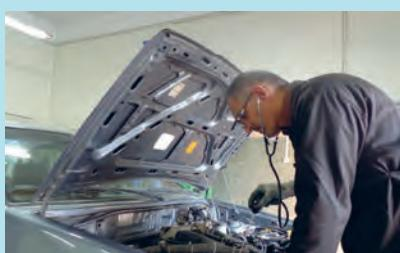
شکل ۲-۱۹- استفاده از گوشی مکانیکی
