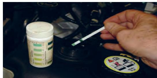
**۱** مانند دستور کار کیت آزمایش، کاغذ آزمایش به مایع با کمک راهنمای روی کیت و رنگ کاغذ، مقدار pH محاسبه خنک‌کننده آغشته شود.
