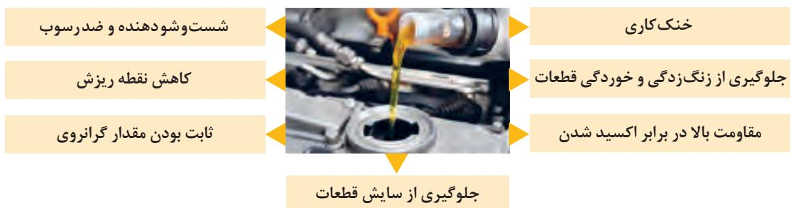
پایین‌ترین دمایی را که روغن در آن دما هنوز می‌تواند جاری شود، نقطه ریزش می‌گویند.
