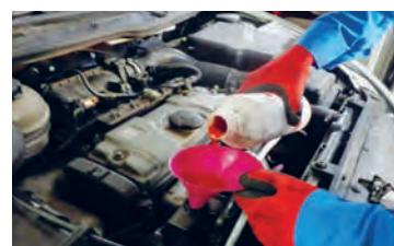
۸ پس از جدای کردن دستگاه وکیوم سطح مایع مخزن بررسی شده و در صورت لزوم به آن اضافه شود.
