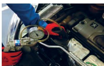
۶ دستگاه وکیوم دوباره روی مخزن بسته شود.
