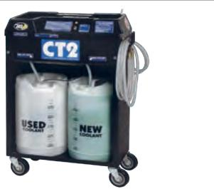
شکل ۷-۳۰- دستگاه تخلیه، شست و شو و شارژ مایع خنک کننده
