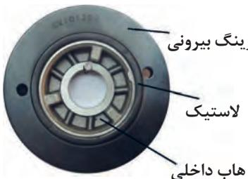
شکل ۲-۹-پولی نوسانگیر (منجیددار)
