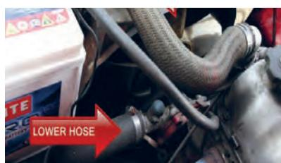
۴ لوله‌های (شیلنگ) رادیاتور و مخزن انبساط بررسی شود.
