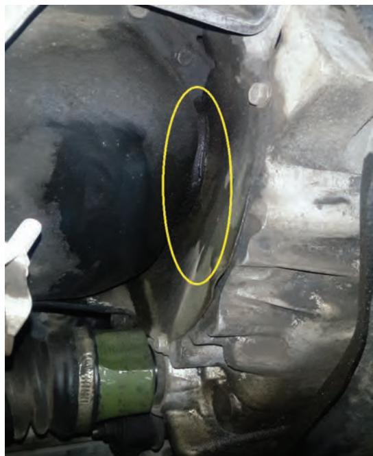
نشتی روغن جعبه‌دنده از عواملی است که اگر برطرف نشود مشکلات اساسی در کارکرد جعبه‌دنده و دیفرانسیل و ایجاد آلودگی‌های زیست‌محیطی درپی دارد. برای همین بررسی محل‌های احتمالی بروز نشتی دارای اهمیت است. شکل ۴-۶ قسمت‌های احتمالی بروز نشتی روغن جعبه‌دنده و دیفرانسیل را برای دو نوع خودروی محرک جلو و محرک عقب نشان می‌دهد.
