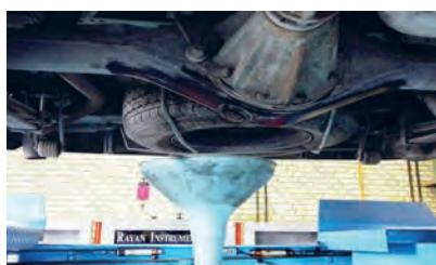
۱ پیچ تخلیه روغن دیفرانسیل باز شود.
