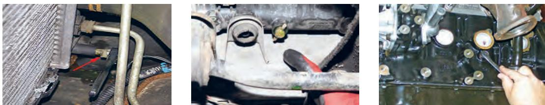
شکل ۷-۲۸- انواع پیچ تخلیه مایع خنک کننده موتور
