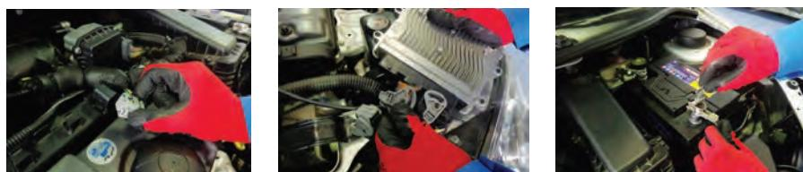
کانکتورهای ECU باز شده و ECU اتصالات باتری جدا شود.
