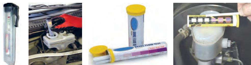
شکل ۶-۶- آزمایش کیفیت مایع هیدرولیک ترمز
