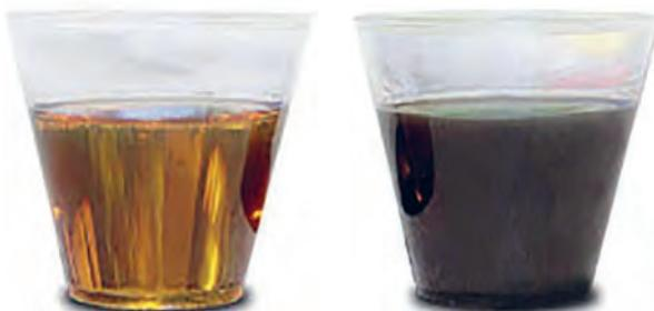
شکل ۶-۴- تفاوت رنگ مایع هیدرولیک ترمز نو و کارکرده
