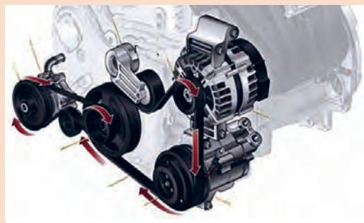
انتقال توان به تجهیزات جانبی با یک تسممه
