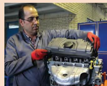
۲ مناسب بودن فیلر سوپاپ‌ها بررسی شود.
