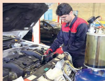
۲ وجود ناخالصی و پلیسه‌های فلزی در روغن بررسی شود.
