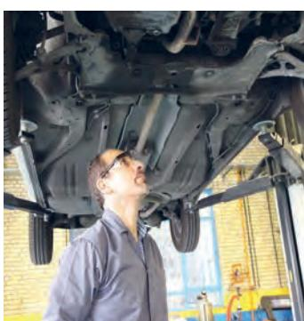
۴ پس از پایان کار، نشتی روغن قبل و بعد از روشن شدن موتور بررسی شود.
