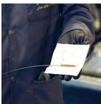
۵ پس از چند دقیقه از خاموش شدن موتور، سطح روغن را بررسی کنید.
