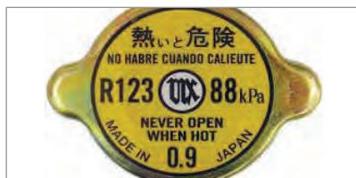
۱ با استفاده از اطلاعات روی در رادیاتور یا کتاب راهنمای خودرو، حداکثر فشار مدار خنک کاری مشخص شود.
