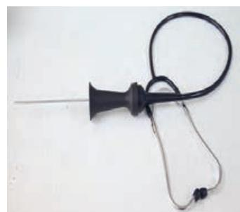
شکل ۲-۱۴- گوشی مکانیکی (استاتوسکوپ) و ابزار بررسی فاصله تسمه و شیار پولی
