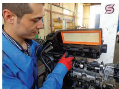
۲ موتور خاموش و با توجه به کتاب راهنمای تعمیرات (گرم یا سرد بودن موتور) در سوپاپ باز شود.
