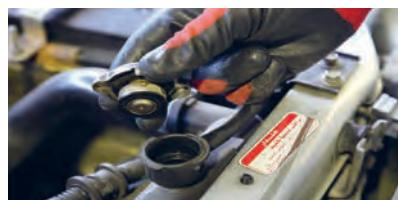
۱ در رادیاتور یا مخزن انبساط باز شود.
