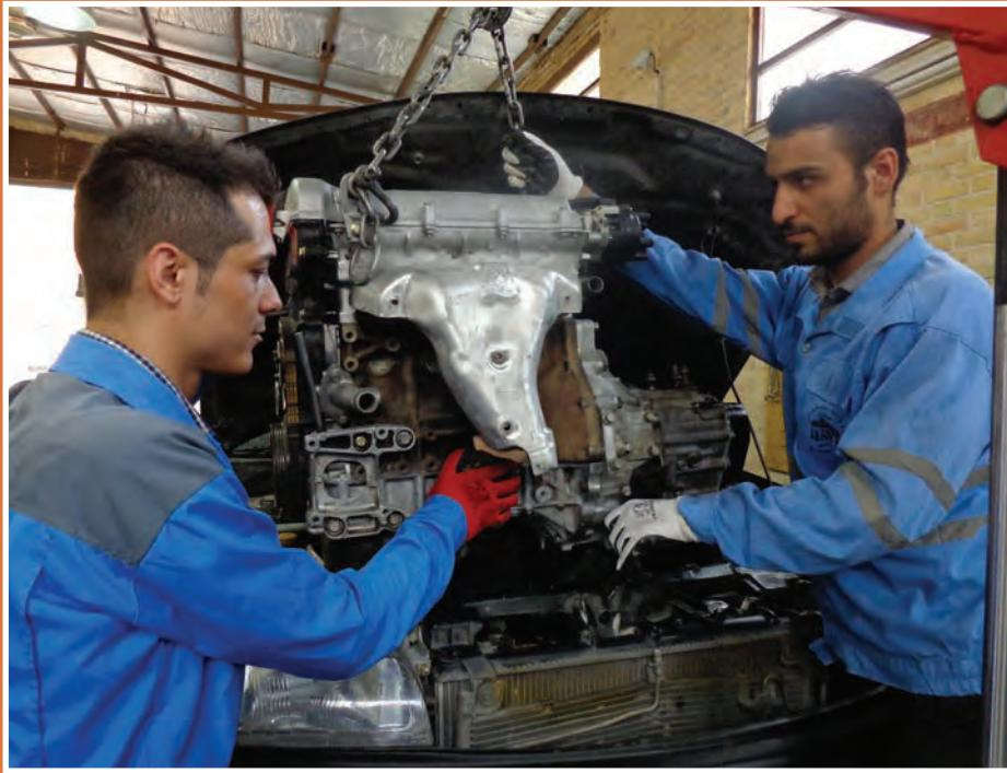
باز کردن موتور از روی خودرو از مراحل مهم تعمیرات موتور خودرو است، آشنایی با چگونگی انجام این کار و مراحل مختلف آن باعث انجام درست و کاهش زمان تعمیرات می‌شود. در این بخش مراحل باز کردن موتور خودروهای جلو محرک و عقب محرک و نکات آن گفته می‌شود.
