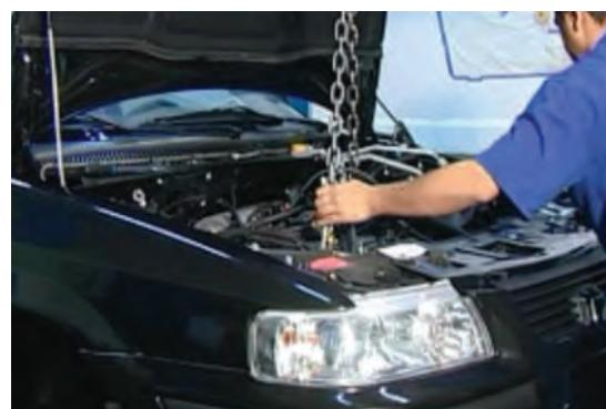
شکل ۹-۱۰- باز کردن دسته موتورها
