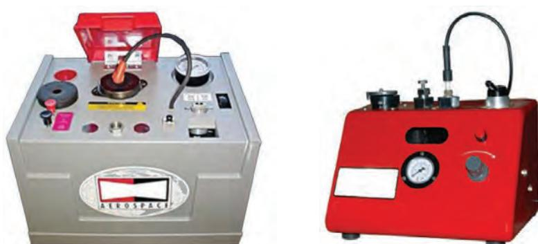
شکل ۸-۳۷- دستگاه شمع پاک کن با قابلیت آزمایش شمع
