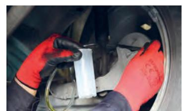
۴ پیچ هوایگیری سفت شود و پدال رها شود.
