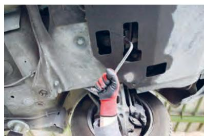
۱ پیچ تخلیه روغن بسته شود.
