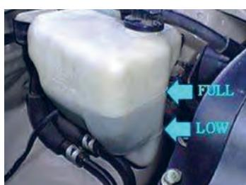
۸ کنار مخزن انبساط ۲ علامت Max (full) و Min (low) وجود دارد. سطح مایع باید بین این دو خط باشد.
