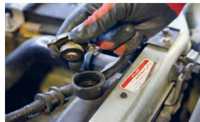
**۱** مایع شست و شوی مخصوص، داخل رادیاتور یا مخزن انبساط ریخته و سپس مدار خنک کاری با آب پر شود.
