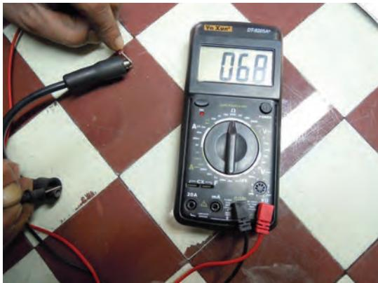
شکل ۸-۳۸- آزمایش اهمی وایر شمع
