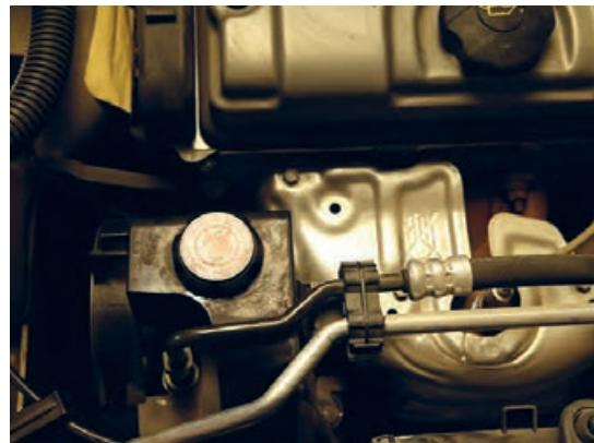
۳ از روی شاخص سطح روی بدنه یا در مخزن، سطح مایع موجود در مخزن بررسی شود. در صورت کم بودن سطح مایع به مرحله نشستی یابی مراجعه و پس از نشستی یابی به مرحله سرریز مراجعه شود.
