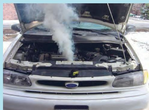
شکل ۷-۱۷- پاشش آب رادیاتور
