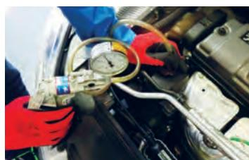
۴ با کمک تبدیل مناسب دستگاه وکیوم دستی روی مخزن بسته شود.
