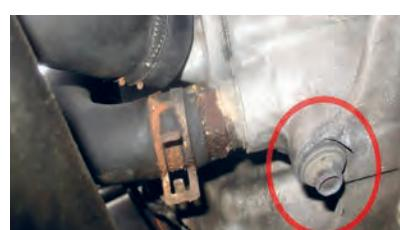
۵ اطراف شیر هوایگیری روی موتور بررسی شود.
