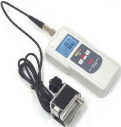
شکل ۸-۴۰- دستگاه کشش سنج تسمه تایم
