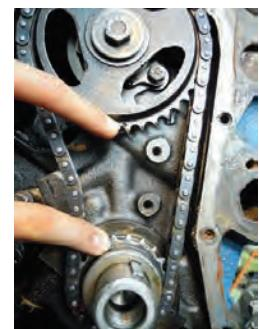
تایم موتور نوع چرخ دنده و تایم موتور تک میل سوپاپ رو، نوع پولی و تسمه زنجیر (بیکان ۱۶۰۰) (پزو ۴۰۵)
