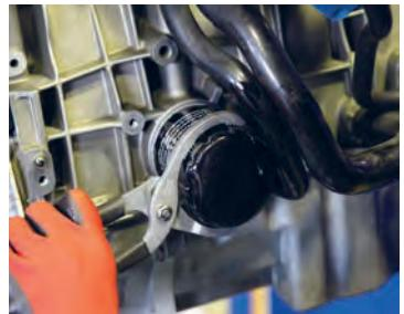
۱ با استفاده از کتاب راهنمای سرویس و تعمیرات، مکان بسته شدن فیلتر مشخص و با آچار مخصوص باز شود.
