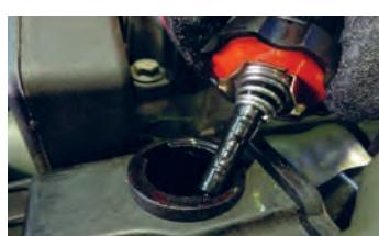
۹ سطح مایع درون مخزن بررسی شده و سپس مدار هوایگیری شود.
