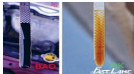
۳ رنگ روغن موتور از نظر شفافیت و سیاه و سفید بودن نیز محل مناسب روی دستگاه آزمایش روغن قرار داده شود.
