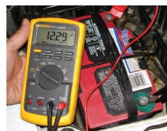
بررسی ولتاژ باتری
