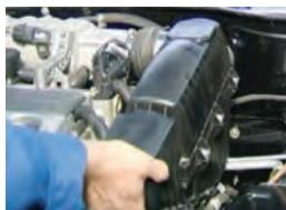
لوله‌های ورودی هوا به موتور باز شوند.
