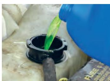
۹ اگر سطح مایع درون مخزن انبساط کمتر از Min باشد با اضافه کردن مخلوط آب و ضدیغ به اندازه مناسب سطح مایع تنظیم شود.
