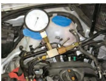
بررسی فشار سوخت
