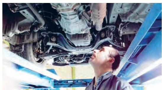
شکل ۴-۶-قرار گرفتن خودرو روی جک بالابر و دیدن محل‌های احتمالی نشتی
