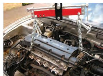
شکل ۱-۹- باز کردن موتور
