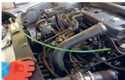
۲ به مایع خارج شده از لوله شفاف توجه شود و زمانی که مایع بدون حباب از آن خارج شد، پیچ هواگیری سفت و نشستی مدار بررسی شود.
