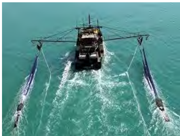
شکل ۵۳- تصویر عملیات توراندازی توسط یک کشتی ماهیگیری ترالردو بازویی از نمای پشت
