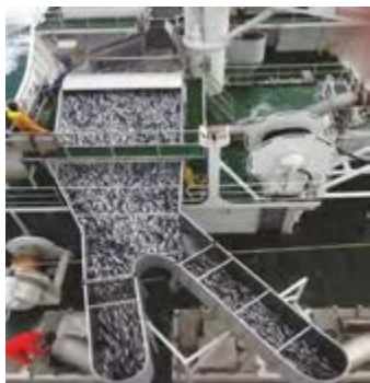
شکل ۱۵- جابه‌جایی ماهیان ریز با پمپ‌های مکند و نوار نقاله در شناورهای مجهز
