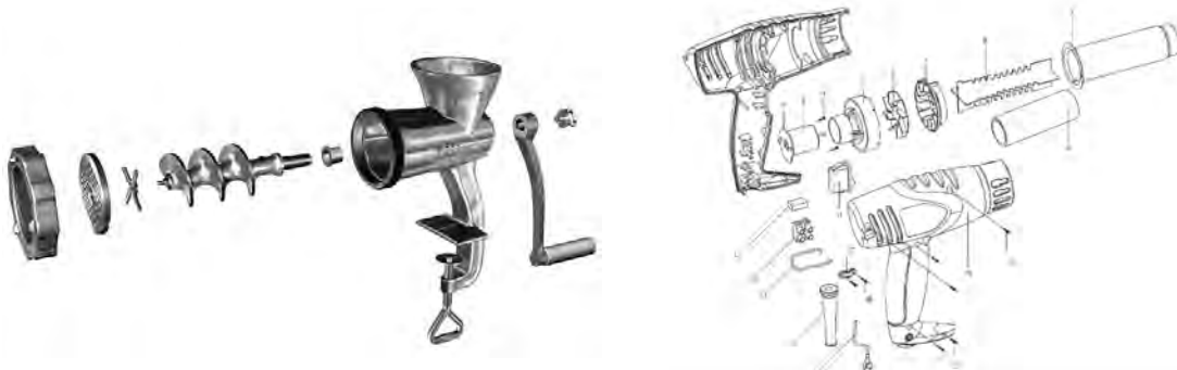
شکل ۶۷- تصویر سه بعدی انفجاری چرخ‌گوش دست‌ساز
