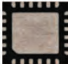
تصویر ظاهری انواع پکیج های DFNT, DFN
