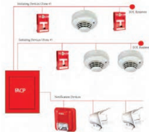
اعلام حریق متعارف
