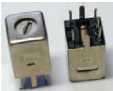
ترانس IF و خازن داخل آن
