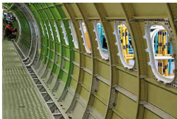
شکل ۳-۱۶ سازه پرچ کاری شده
