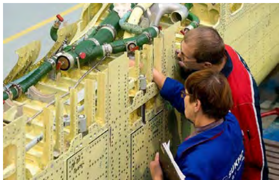
شکل ۳-۱۷ بازدید سازه پرچ کاری شده
