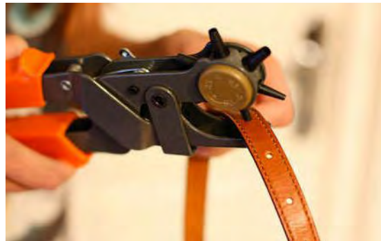
الف) شکل ۳-۱۹ پرچ سوراخ کمر بند
