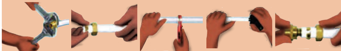
شکل ۴۴- مراحل اتصال لوله پکس
