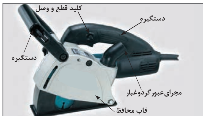
شکل ۱۲- اجزای دستگاه شیارزن
