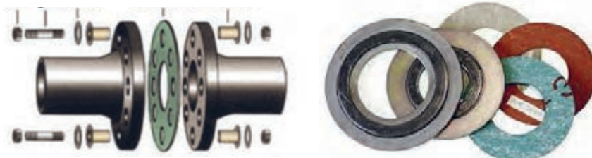
شکل ۳۵- نحوه قرارگیری واشر آب‌بندی
