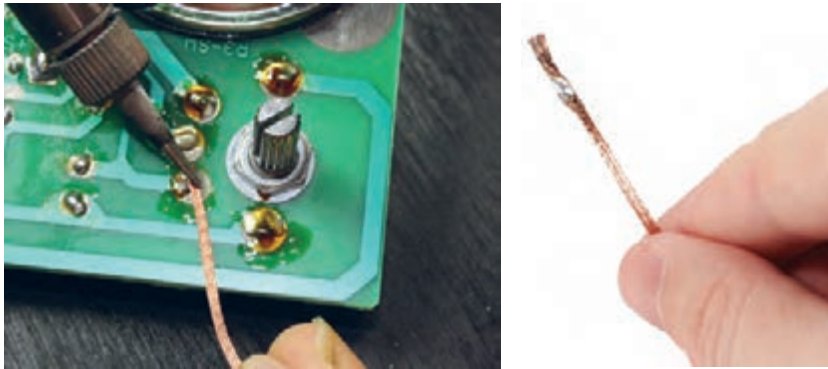
شکل ۸۰-۱- برداشتن قلع از روی فیبر
