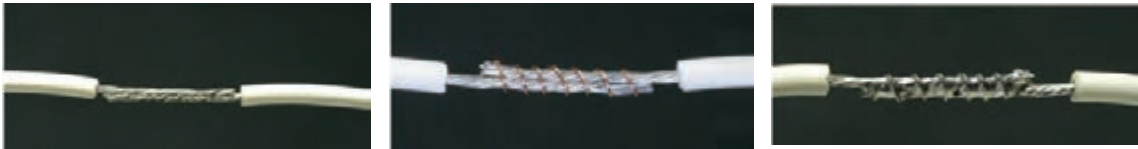
شکل ۶۰-۱- اجرای یک اتصال ساده
