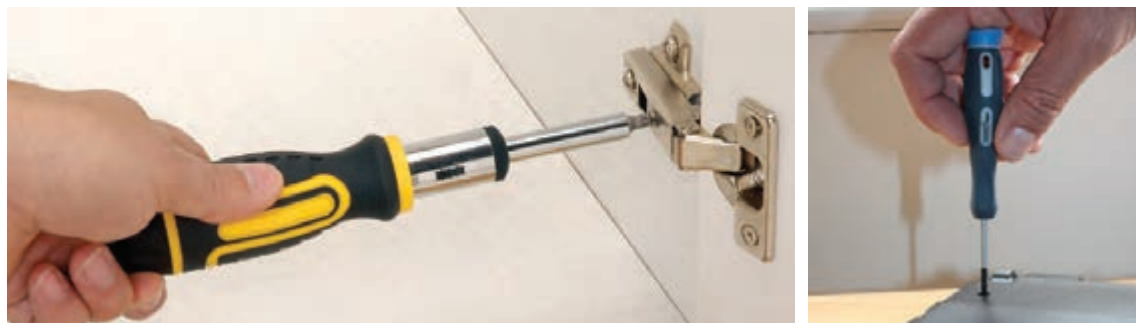
شکل ۳۱-۱- چگونگی صحیح در دست گرفتن پیچ گوشتی
