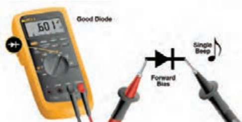
شکل ۳-۶- وضعیت تست دیود در بایاس موافق
