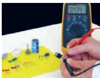
شکل ۷-۳- اطمینان از سالم بودن قطعات
