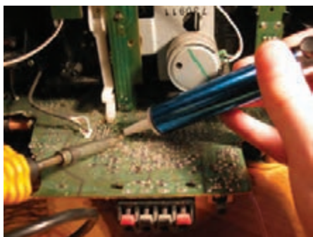
شکل ۸۴-۱- مراحل ذوب شدن و مکش قلع
