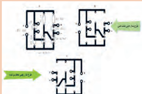
شکل ۱۵-۵- طرح مدار چاپی معکوس شده
