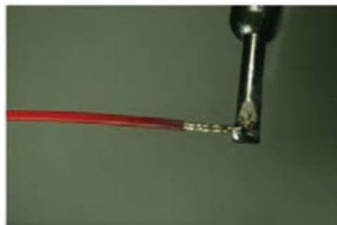
جاری شدن و نفوذ لحیم روی سیم مسی
