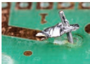
شکل ۹۲-۱- (اینفو گرافیک) نمونه‌هایی از لحیم مشکل دار
