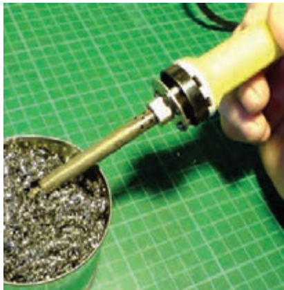
شکل ۴۲-۱ - تمیز کردن نوک هویه با اسفنج مخصوص
