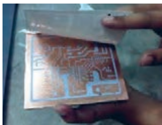
شکل ۱۱-۷- جدا کردن کاغذ از سطح روی فیبر
