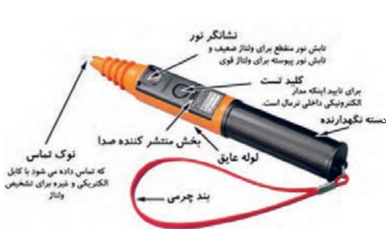
شکل ۳۸-۲- ساختمان داخلی فازمتر دیجیتالی
