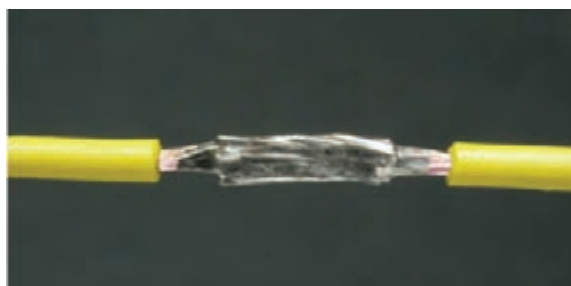
شکل ۱-۵۵- اتصال لحیم کاری کامل است.
