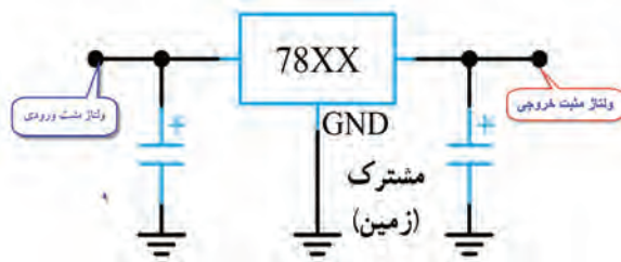
شکل ۷۱-۳- مدار استاندارد قرار گرفتن آی‌سی در مدار
