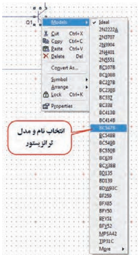
شکل ۱۹-۶- نحوه انتخاب نام و مدل ترانزیستور
