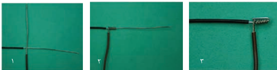
شکل ۱-۵۲- اتصال سیم افشان به سیم مفتولی
