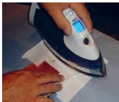
شکل ۹-۷- کشیدن اتو روی کاغذ و فیبر
