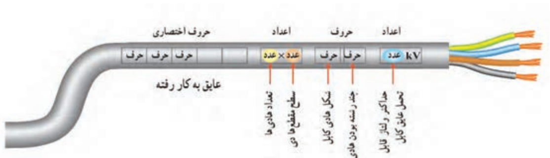
شکل ۲-۱ - مشخصات فنی یک نوع کابل
