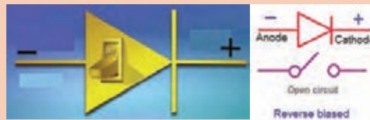
شکل ب ۸-۳- دیود ایده‌آل در بایاس مخالف
