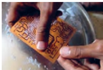
شکل ۱۱-۷- جدا کردن کاغذ از سطح روی فیبر
