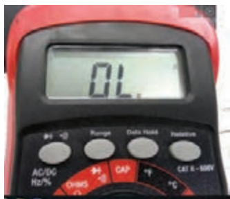
شکل ۳-۶- وضعیت تست دیود در بایاس موافق
