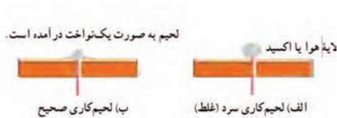
شکل ۵۰-۱- لحیم‌کاری صحیح و غلط
