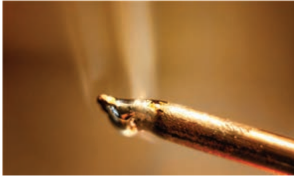
شکل ۴۱-۱- فرو بردن نوک هویه در روغن لحیم
