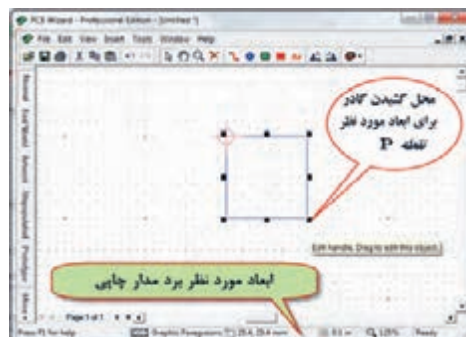
شکل ۳۸-۶- نحوه تعیین اندازه برد مدار چاپی
