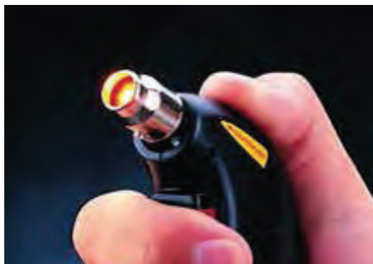
شکل ۶۱-۱- دستگاه گرم کن برای وارنیش حرارتی
