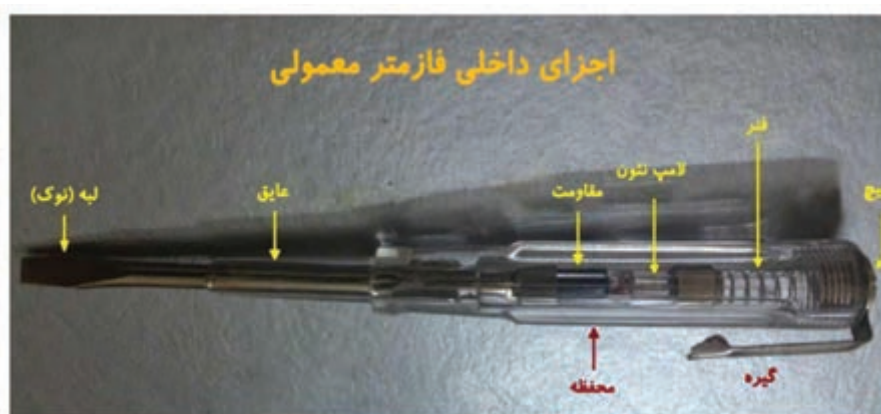
شکل ۲-۳۷- ساختمان داخلی فازمتر
