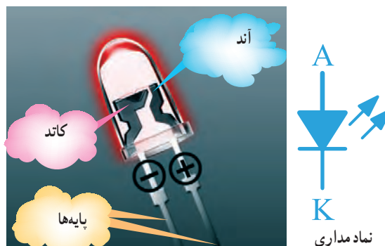
شکل ۳۰-۱۳ نماد فنی و ساختمان داخلی LED
