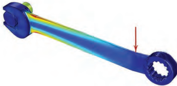
شکل ۵-۱۲- قسمت‌های بحرانی یک آچار هنگام بارگذاری
