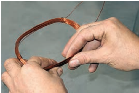
شکل ۳۸-۲ مرتب کردن سیم‌ها جهت کلاف گذاری
