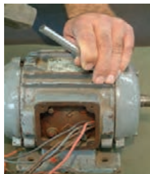
شکل ۱۸- باز کردن پیچ‌های موتور و درپوش‌ها
