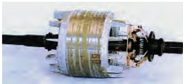
شکل ۹- محل قرار گرفتن کلید گریز از مرکز
