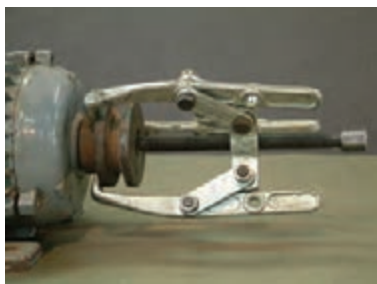
شکل ۱۷- درآوردن پولی از محور موتور
