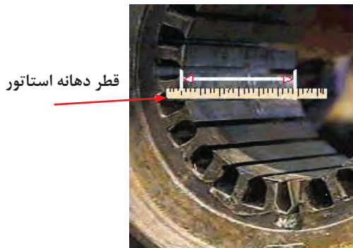
شکل ۲۷- اندازه گیری طول و قطر داخلی استاتور
