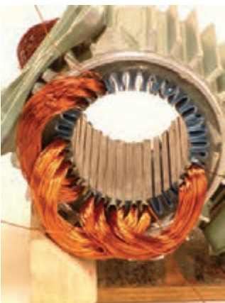
شکل ۶۸- قرار گرفتن سومین گروه کلاف در شیارها
