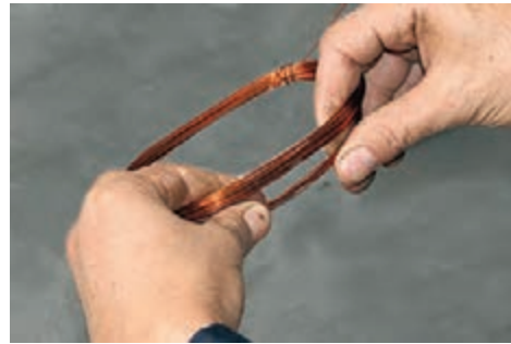
شکل ۳۸-۱ طریقه در دست گرفتن کلاف
