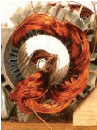
شکل ۶۹- درآوردن بازوهای ۱،۲،۳ برای قرار دادن کلاف آخر
