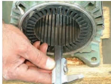
شکل ۲۷- اندازه گیری طول و قطر داخلی استاتور
