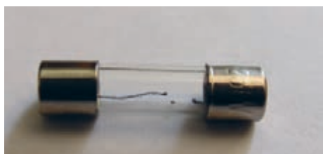
شکل ۱۶ - فیوز آسیب دیده است.
