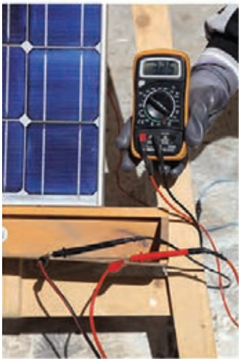
شکل ۱۵-۲ اندازه‌گیری جریان اتصال کوتاه
