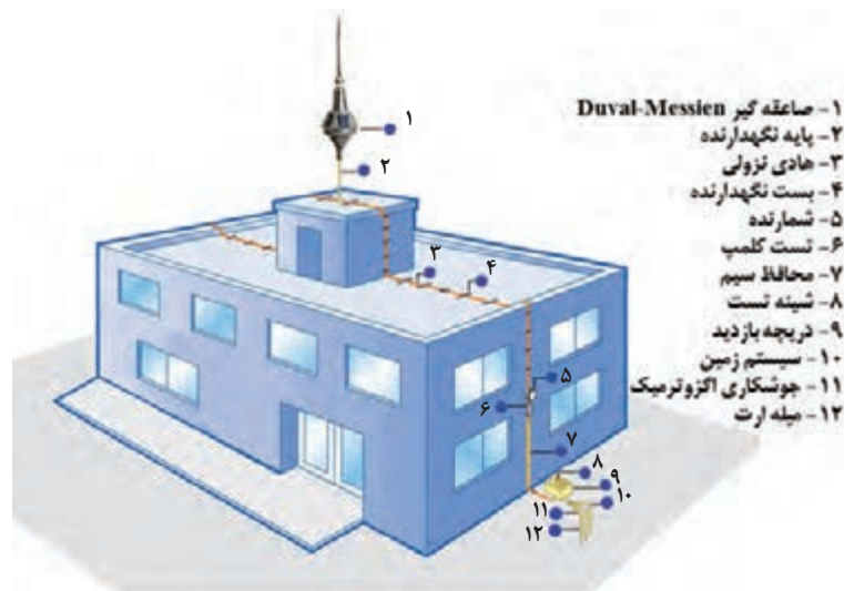
شکل ۴۱- تجهیزات صاعقه گیر
