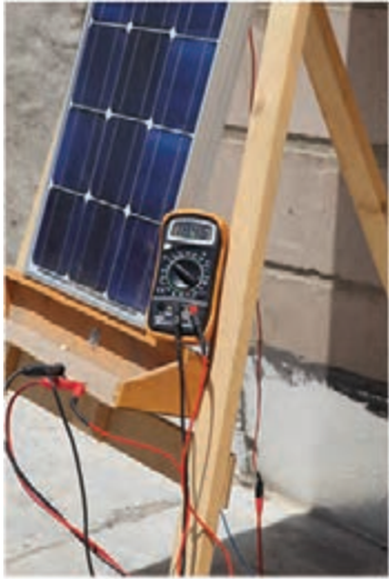
شکل ۱۵-۱ اندازه‌گیری ولتاژ بی‌باری
