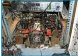
شکل ۳۴ - سوختگی در اثر صاعقه
