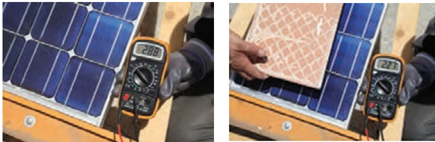
شکل ۷- ب - اثر سایه بر جریان اتصال کوتاه
