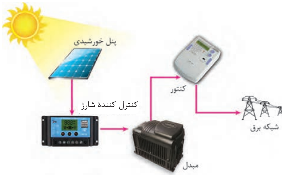
شکل ۵۱- نقشه ارتباط عناصر سیستم فتوولتائیک On_Grid
