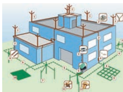
شکل ۳۸ – پراکنده کردن صاعقه در زمین
