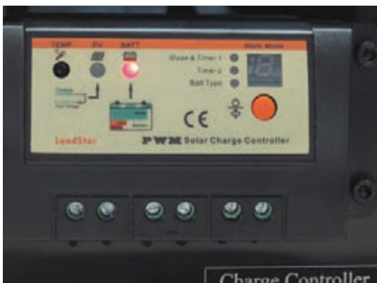
شکل ۳۶- با اتصال باتری LED روشن می شود.
