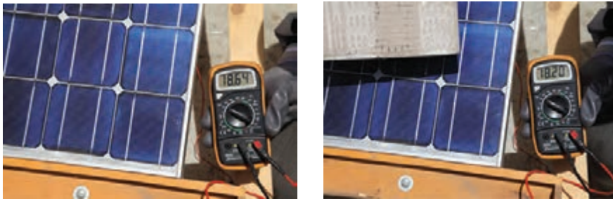
شکل ۷- الف - اثر سایه بر ولتاژ بی‌باری
