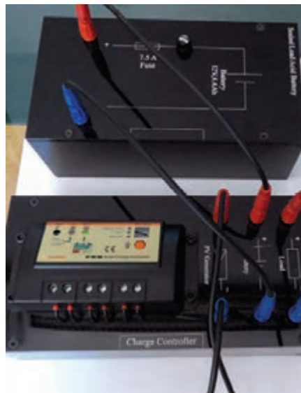
شکل ۳۷ - اتصال کنترل کننده شارژ به مدول
