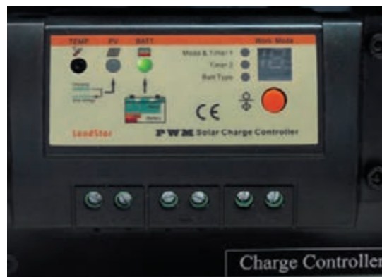
شکل ۳۶- با اتصال باتری LED روشن می شود.
