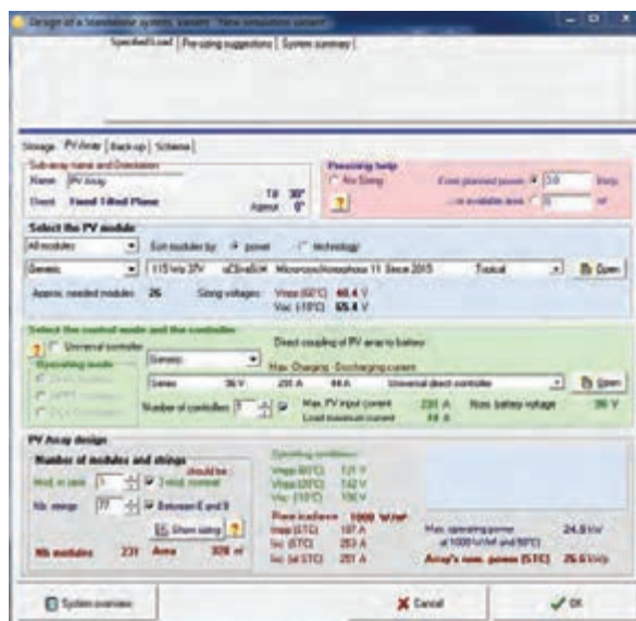
شکل ۳۸ - مقادیر مدول PV، کنترل شارژ
