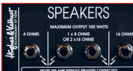
شکل ۲۰- امپدانس خروجی بلندگو
