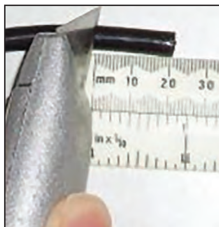
۳- یک قسمت از سیم بافته را کنار زده و عایق زیرین را از میان آن بیرون بکشید.
