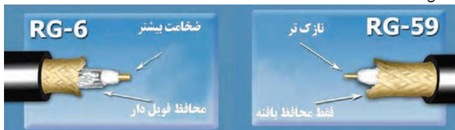
شکل ۴- مقایسه دو نوع کابل RG
