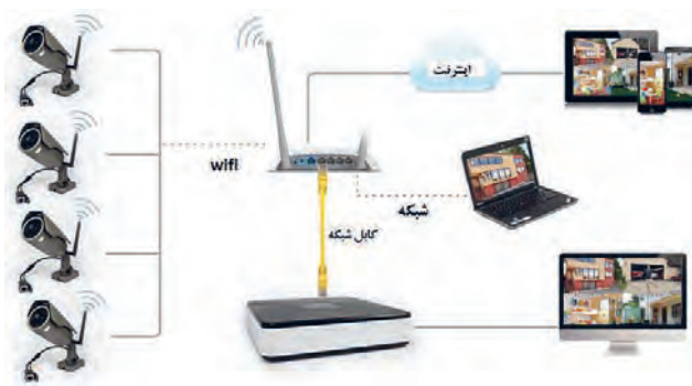
شکل ۳۸- اتصال دوربین‌های IP
