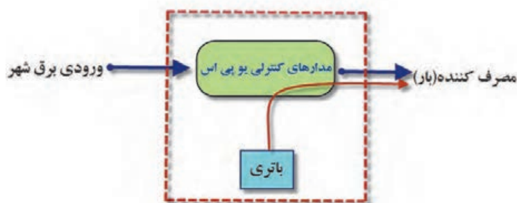
شکل ۳- مدار کنترلی یو پی اس
