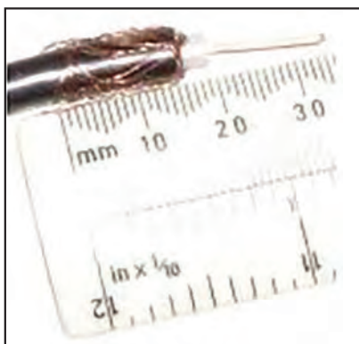
۴- عایق زیر را نیز روکش برداری کنید.
