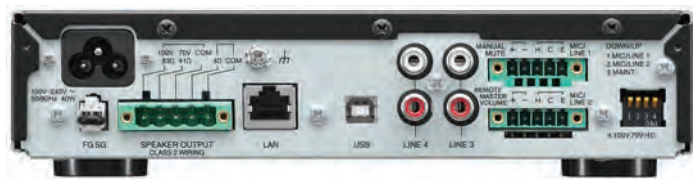
شکل ۱۹- اتصالات آمپلی فایر
