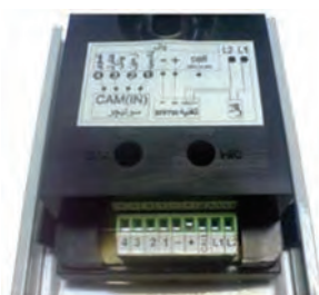
شکل ۲۵- محل تنظیم صدای بلندگو و میکروفون
