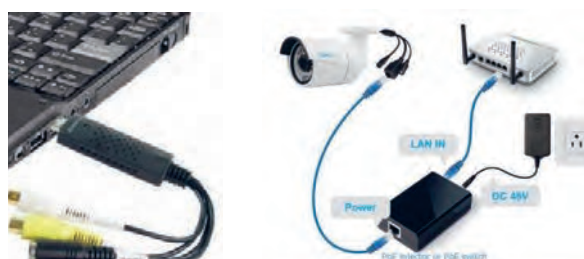
شکل ۲۸- اتصال دوربین IP
