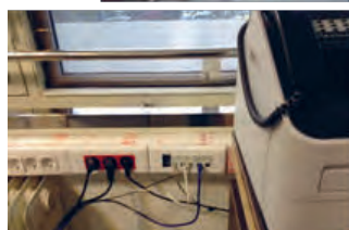
شکل ۱۶ - اتصال چند بار مختلف به UPS
