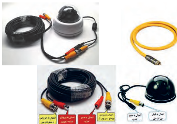
شکل ۲۴ - اتصالات دوربین و مبدل‌های AV به BNC
