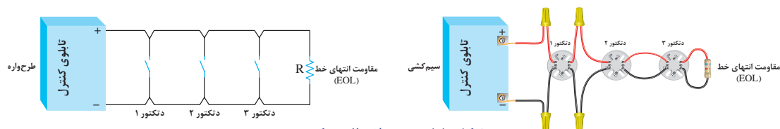
شکل ۵۵- نحوه اتصال دکتور
