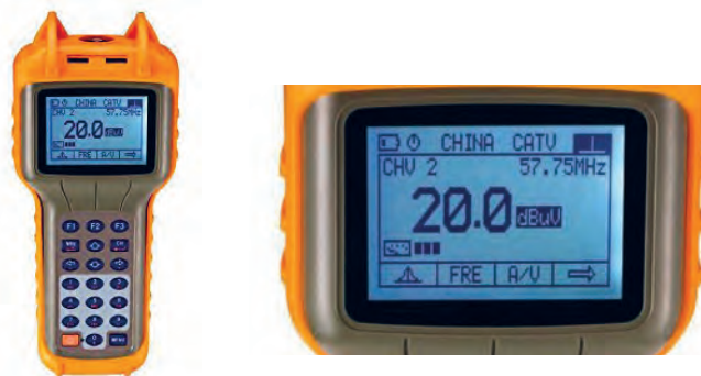
شکل ۲۴- اندازه‌گیری سیگنال خروجی آنتن توسط سیگنال سنج
