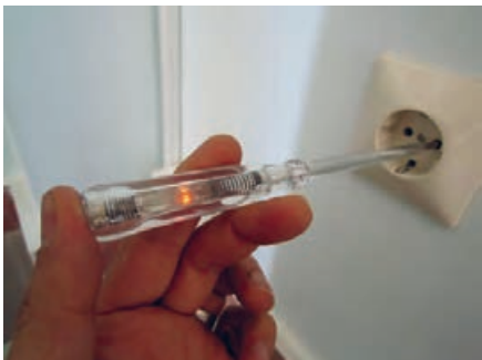
شکل ۴ - کاربرد صحیح فازمتر
