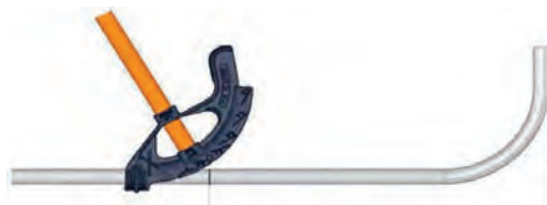
شکل ۲۷- اجرای خم دوم
