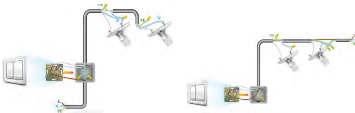
شکل ۲۷ - مدار کلید دورااهه (دوبل)
