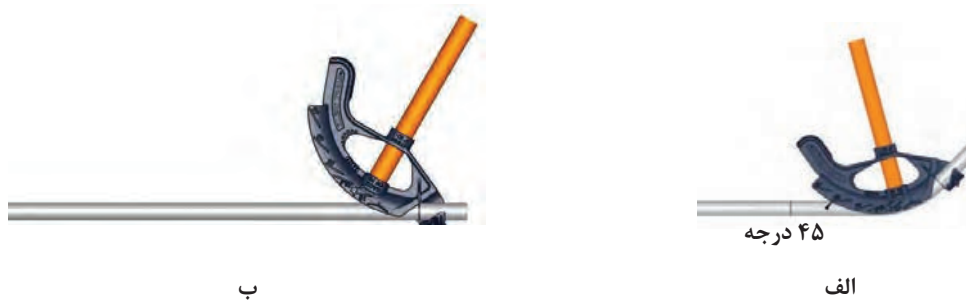
شکل ۳۳- خم انحرافی با لوله خم کن دستی
