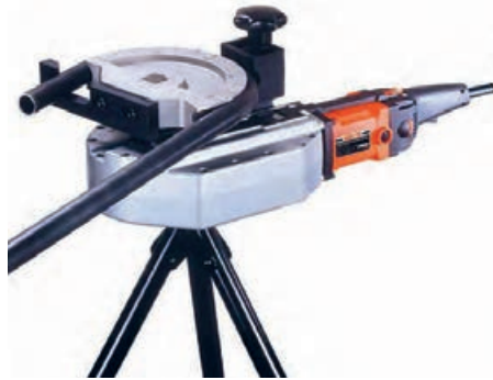
شکل ۱۷- خم کردن لوله
