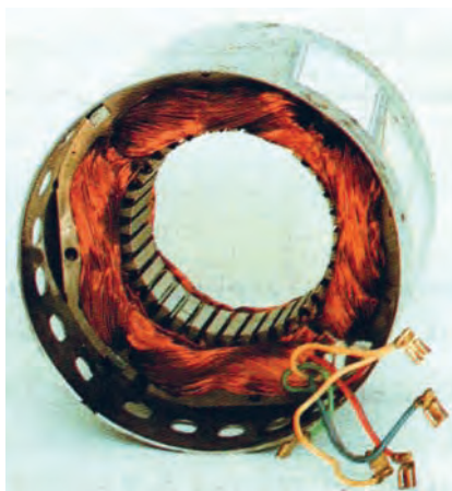
شکل ۷۰- سرسیم‌ها و سیم‌پیچی‌های موتور الکتریکی کولر آبی
