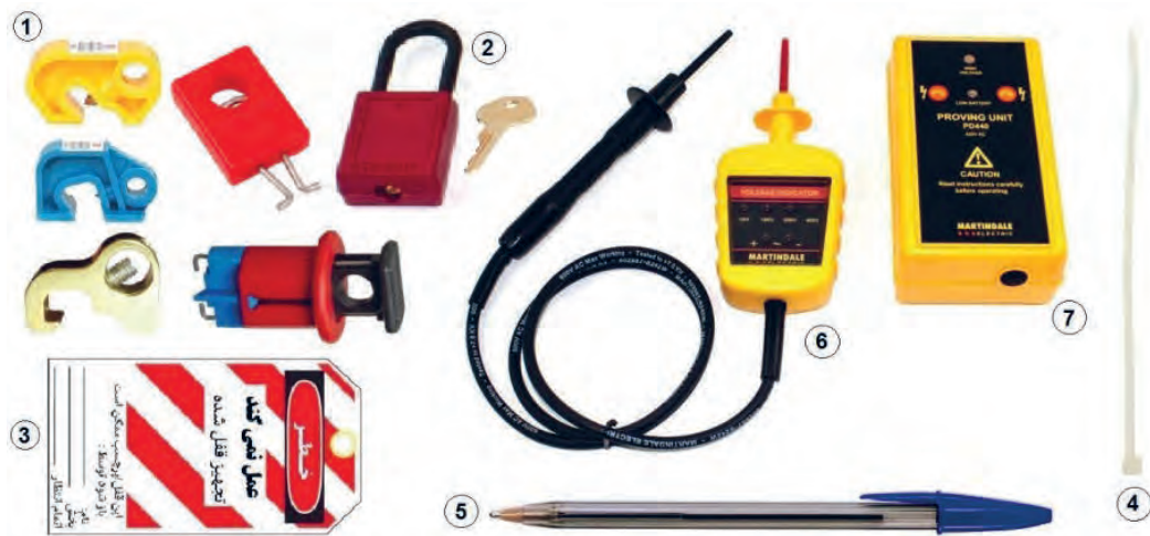
شکل ۵۱- تجهیزات لازم برای جداسازی ایمن
