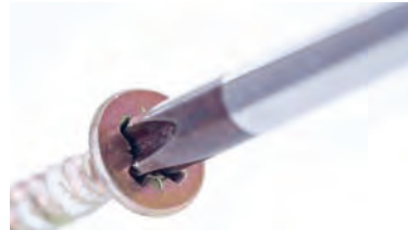
الف) استفاده صحیح از آچار پیچ گوشتی
