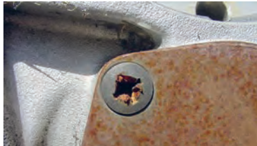
ب) استفاده ناصحیح از آچار پیچ گوشتی
