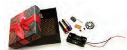
شکل ۲۱-۲- ابزار و قطعات مورد نیاز برای ساخت جعبه آهنگین
