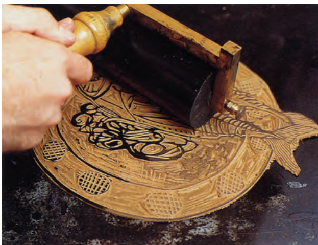
تصویر ۶۱- مرکبی کردن کلیشه. بهتر است هنگام مرکب زدن کلیشه آن را روی روزنامه یا کاغذ کاهی قرار دهید تا از رنگی شدن میز جلوگیری کنید.
