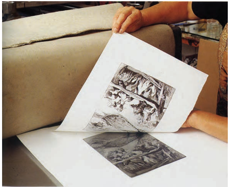
تصویر ۱۸۶- برداشتن کاغذ چاپ شده از روی کلیشه
