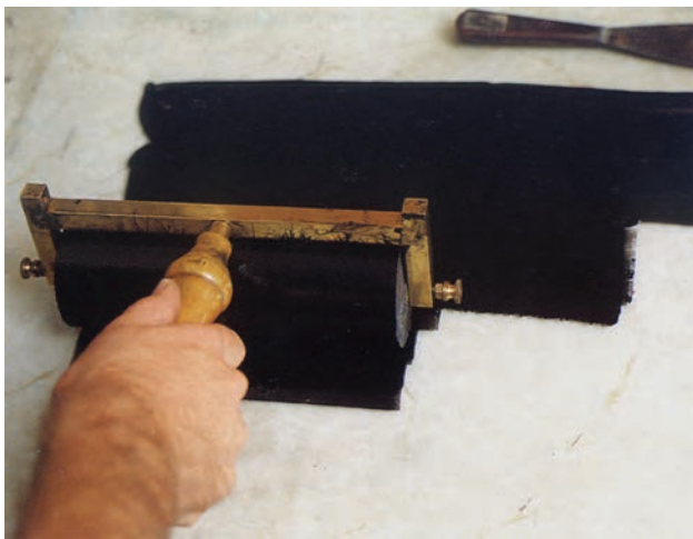
تصویر ۶۰- پخش کردن مرکب روی سطح شیشه
