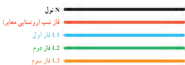
▲ شکل ۱-۶- نامگذاری سیم‌های تیر چراغ برق
