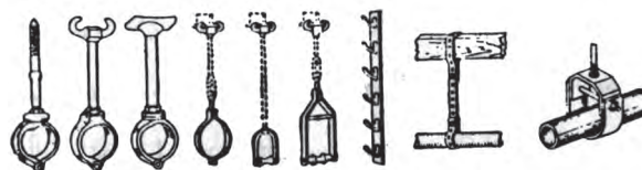
▲ شکل ۱۸-۸ - انواع بست لوله
