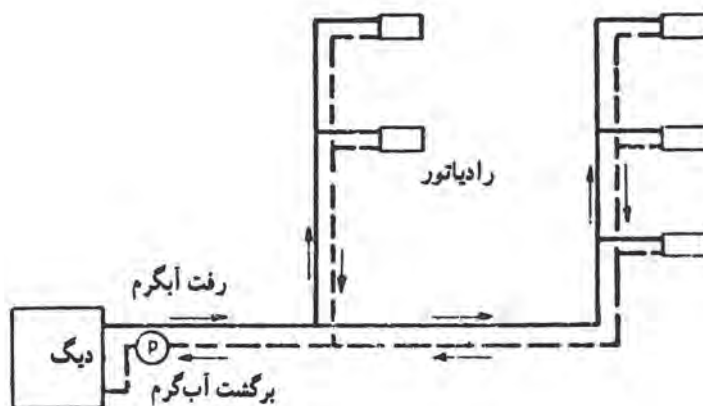
▲ شکل ۹-۳- حرارت مرکزی با آب گرم
