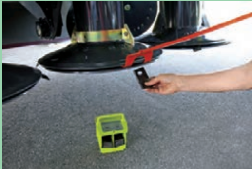
شکل ۲۰- نحوه تعویض تیغه در دروگر استوانه‌ای
