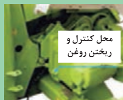
شکل ۶۵- جعبه دنده باردهی غلتک‌های تغذیه
