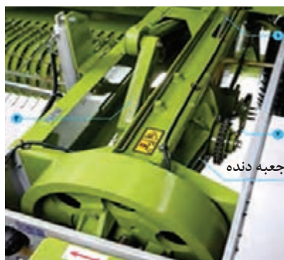
شکل ۱۲- مسیر انتقال توان در دستگاه بسته‌بند
