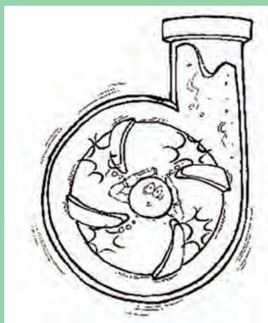
شکل ۱۵- کاویتاسیون در پروانه پمپ
