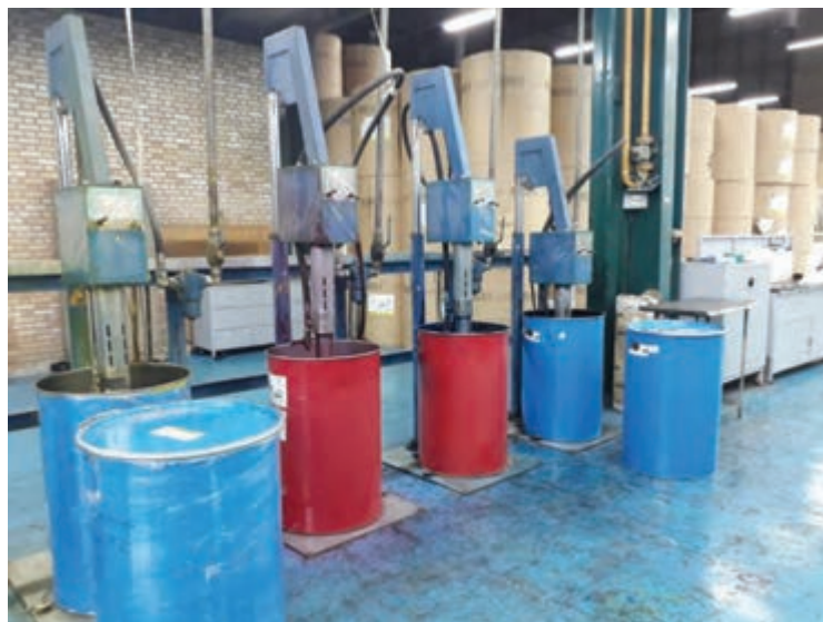
شکل ۷۷- مکانیزم تغذیه خودکار مرکب
