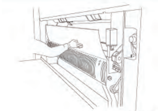
شکل ۷۳- نصب آستراگون به وسیله پلیت
