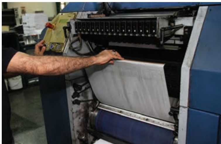
شکل ۵۶- نگاه‌داشتن پلیت برای بازکردن از روی سیلندر
