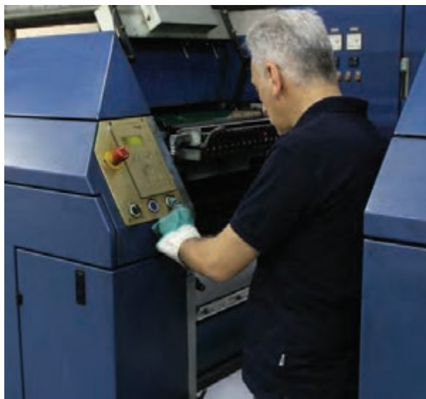
شکل ۷۳- استفاده از کلید حلزونی
