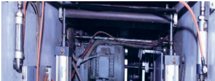
شکل ۳۸- جک های هیدرولیک سیلندر ضربه زننده
