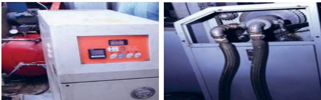
شکل ۲۷- سیستم گرمایشی سیلندر فشار
