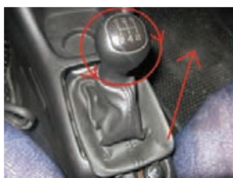
شکل ۲-۲۵- خارج کردن سری و گردگیر دسته دنده
