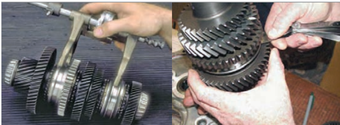
فیلر زدن برای بررسی لقی محوری چرخ‌دنده بر روی شفت
