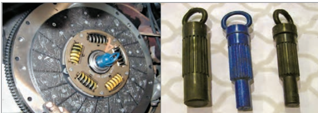
شکل ۱-۳۷- نحوه قرارگیری شفت هم محور کننده صفحه کلاچ
