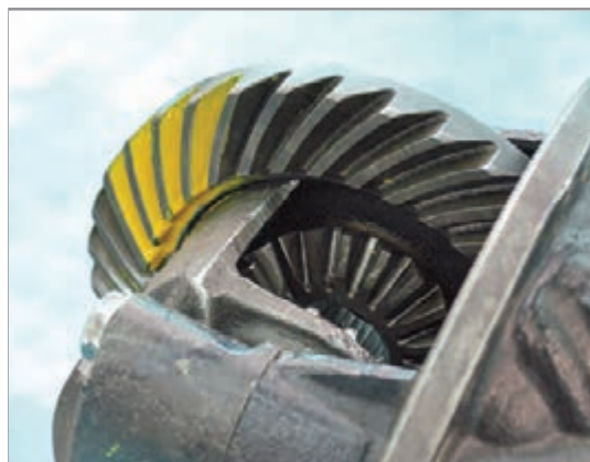
شکل ۴-۲۸- استفاده از رنگ برای کنترل
