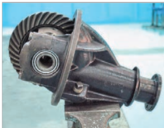
شکل ۴-۲۷- بستن مجموعه دیفرانسیل روی گیره
