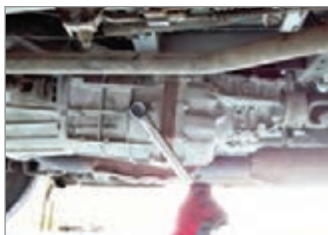
شکل ۲-۲۳- پر کردن روغن جعبه‌دنده
