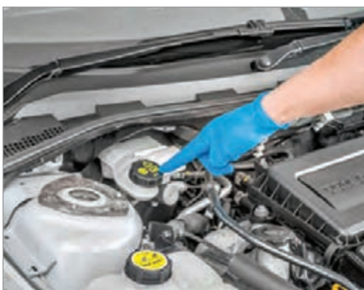
شکل ۱۶-۱- مخزن مایع مشترک در یک خودرو
