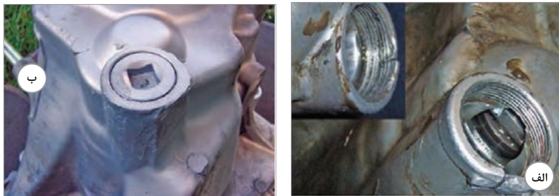
شکل ۲-۳۴- پوسته جعبه‌دنده و نحوه ترمیم آن
