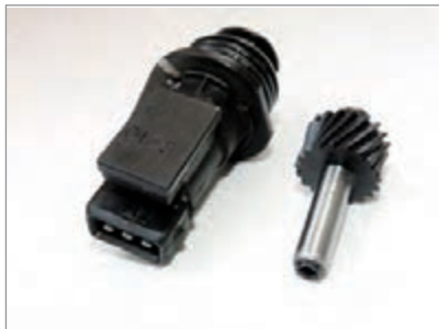
شکل ۲۲-۲- حسگر سرعت خودرو روی جعبه‌دنده
