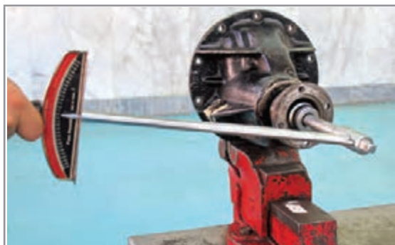
شکل ۴۸-۴-ب تعیین گشتاور پیش بار با گشتاورسنج
