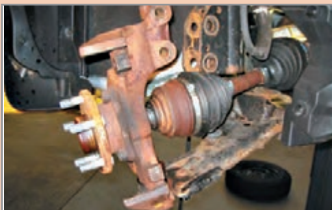
باز کردن پایه کمک‌فنر از سگدست در صورت لزوم
