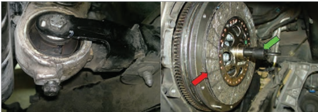
بررسی دسته نگهدارنده جعبه‌دنده
