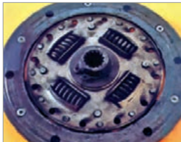
شکل ۲۷-۱- نمونه صفحه کلاچ معیوب سوختگی و سایش بیش از حد
