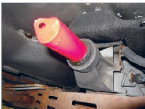
شکل ۱۹-۳- استفاده از ابزار مخصوص کورکن
