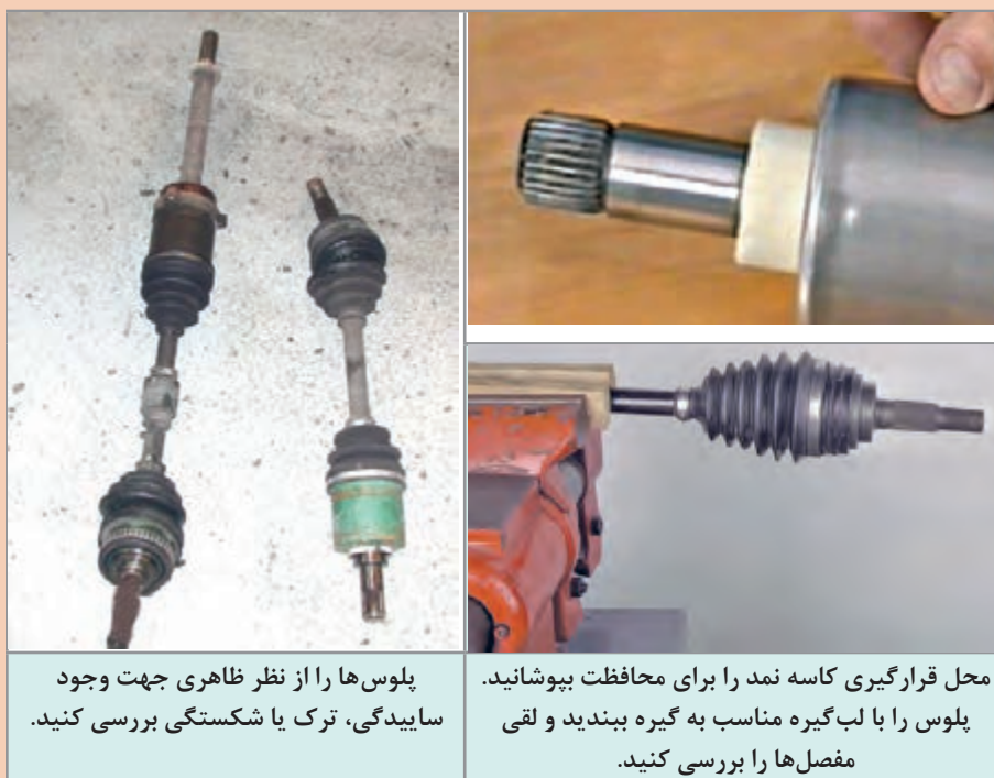
شکل ۲۰-۵ - نکات مورد توجه هنگام بررسی پلوس‌ها
