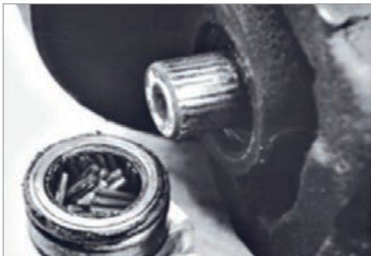
شکل ۲۳-۳- بررسی ساچمه سوزنی
