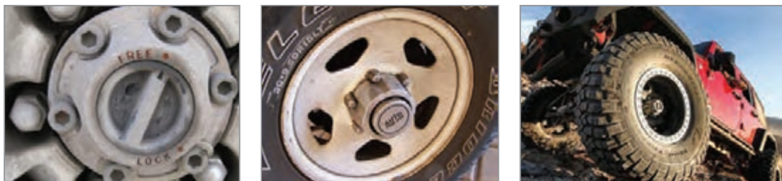
شکل ۵-۱- قفل روی چرخ (قفل پلوس) روی برخی خودروها
