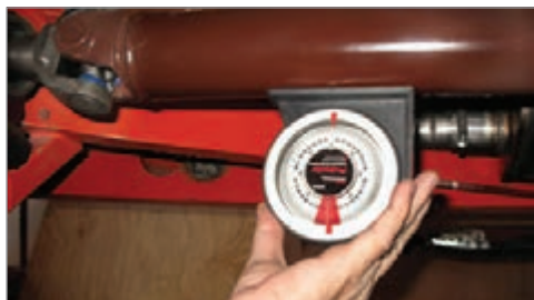
شکل ۱۳-۳- روش استفاده از زاویه سنج میل گاردان
