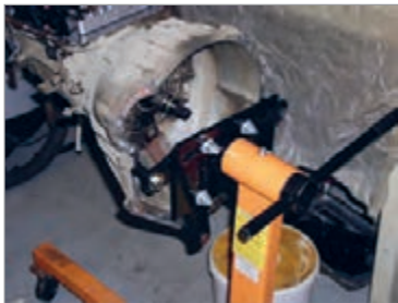
شکل ۲-۳۰- انواع استند تعمیراتی جعبه‌دنده و نحوه نصب آن
