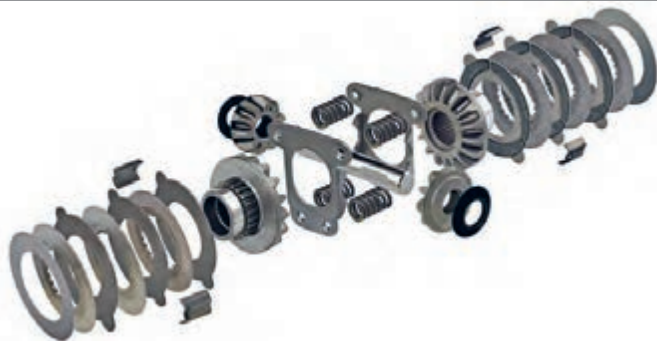
شکل ۴-۴ اجزای دیفرانسیل ضد لغزش
