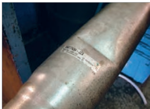
شکل ۱۵-۳- مشاهده آثار ضربه روی سطح میل گاردان
