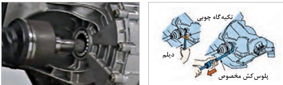
شکل ۱۹-۵ - خارج کردن پلوس با ابزار مخصوص
