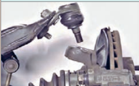
باز کردن پایه کمک‌فنر از سگدست در صورت لزوم
