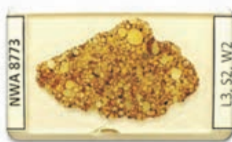
۹- چسباندن لامل روی نمونه و آماده شدن مقطع نازک جهت مطالعه
