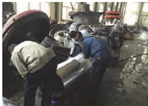
سرویس و نگهداری سنگ‌شکن مخروطی
