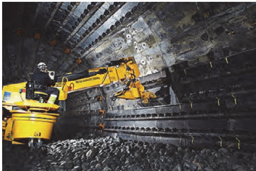
نحوه تعویض آسترهای دستگاه آسیا
