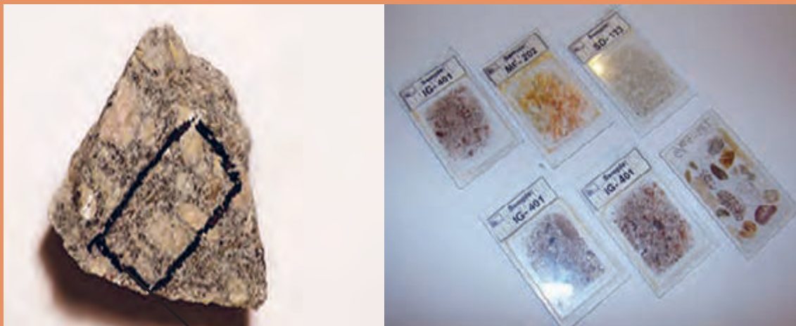
قسمت مشخص شده از نمونه جهت تهیه مقاطع نازک و یا صیقلی
