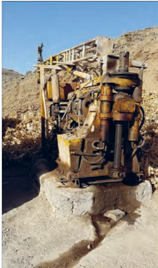
دستگاه حفاری قرار گرفته بر روی فونداسیون
