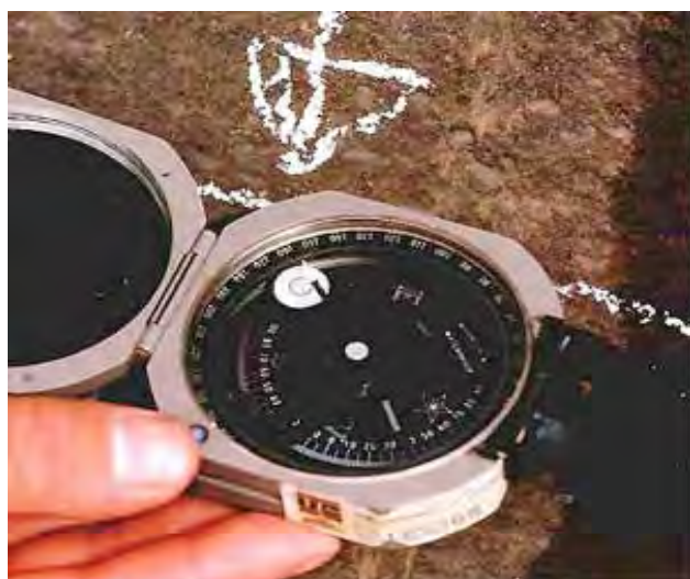
تماس لبه کمپاس با سطح لایه برای به دست آوردن امتداد
