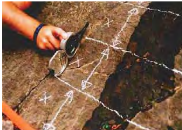
قرارگیری لبه کمپاس عمود بر امتداد لایه برای به دست آوردن شیب آن
