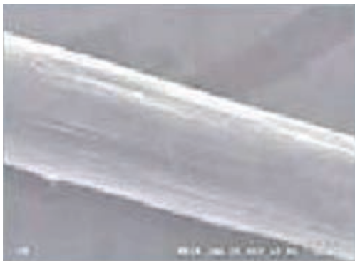
شکل ۱۳- نمای طولی و الیاف کازئین
