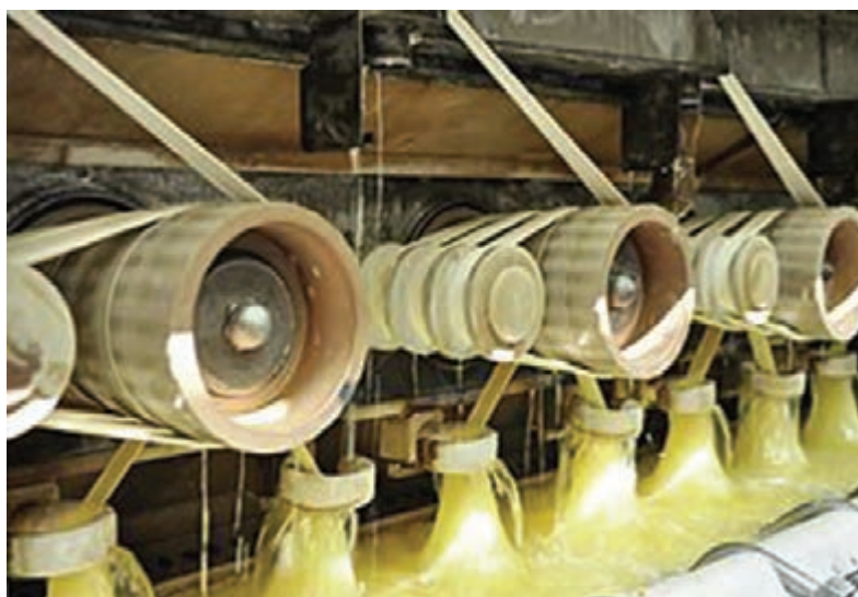
شکل ۸- خروج الیاف از حمام انعقاد و پیچش الیاف
