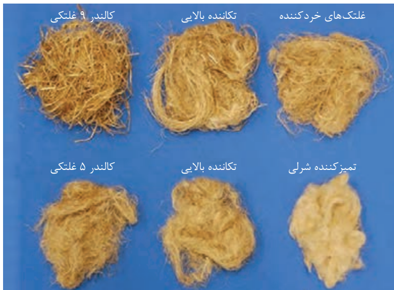
شکل ۱۸- تصویر الیاف کتان پس از انجام مراحل مختلف
