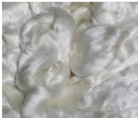
شکل ۱۳- نمای طولی و الیاف کازئین
