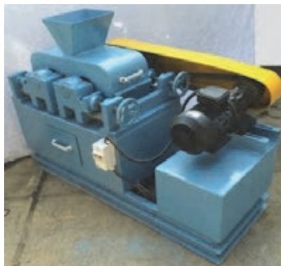
شکل ۳۱- سنگ شکن غلتکی آزمایشگاهی
