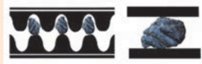
شکل ۲۱- انواع زره مخصوص سنگ‌شکن فکی
