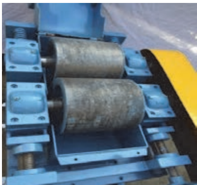
شکل ۳۱- سنگ شکن غلتکی آزمایشگاهی
