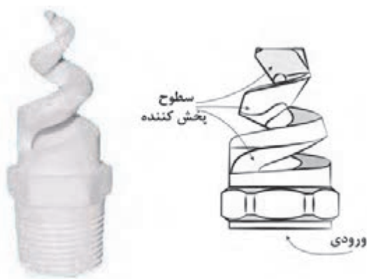
شکل ۲۴- افشانک نازلی نوع حلزونی
