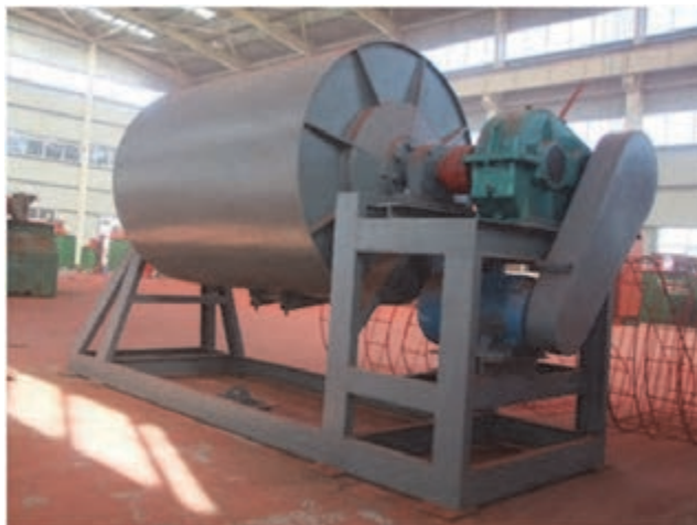
شکل ۱۱- بال میل ناپیوسته
