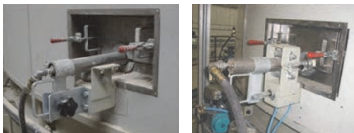
شکل ۳۴- لنس های متصل به لوله های اسپری درایر
