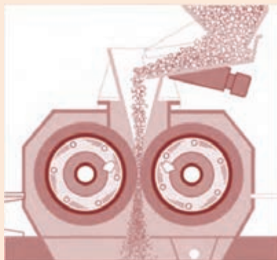
شکل ۳۰- جهت چرخش استوانه‌ها در سنگ شکن غلتکی
