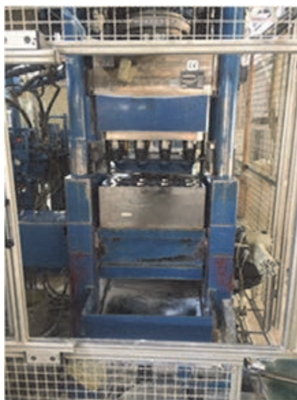
شکل ۱۳- پرس ایزواستاتیک گلوله آلومینایی
