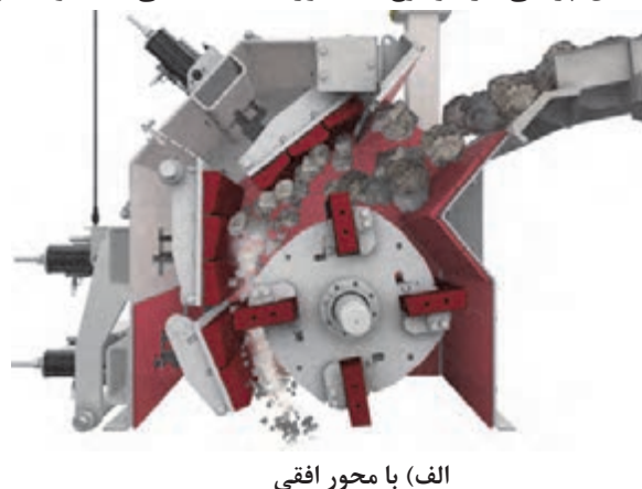
شکل ۳۲- سنگ شکن نوع پرتابی
