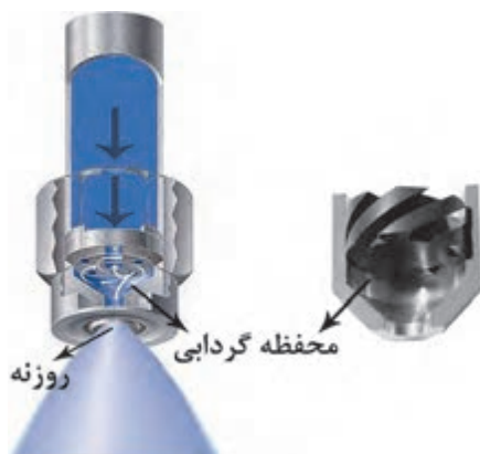
شکل ۲۵- افشانک نازلی نوع گردابی
