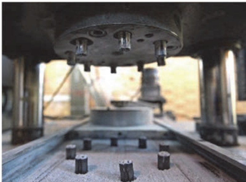
شکل ۱۱- پرس با قالب حاوی ۸ حفره
