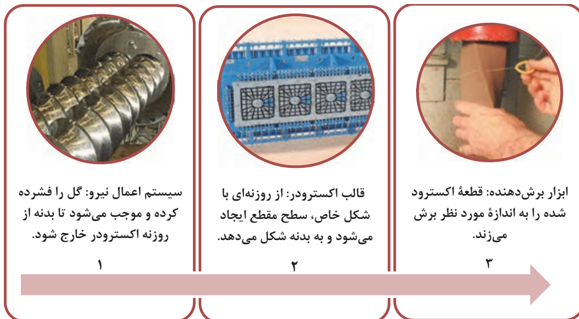
شکل ۵- اجزای ماشین اکسترودر
