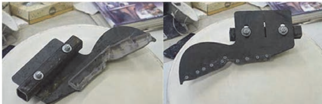
شکل ۱۶- شابلون با پیچ و مهره قابل تنظیم
