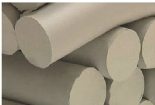
شکل ۵- اکستروود کردن گل پلاستیک
