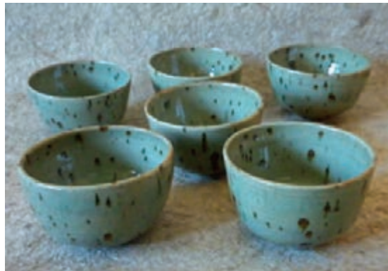
شکل ۵۶- اثر افزودن ۴ درصد بنتونیت در ترکیب لعاب
