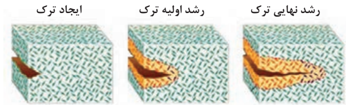
شکل ۲۲- گسترش ترک و مقاومت ماده در برابر آن (چقرمگی)
