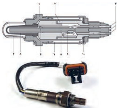
شکل ۵- اجزای حسگر اکسیژن
