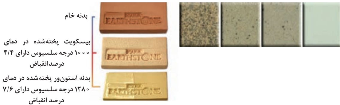
شکل ۵۱- انقباض و متراکم شدن بدنه
