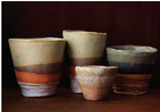
شکل ۵۷- رنگی شدن بدنه به علت وجود بنتونیت
