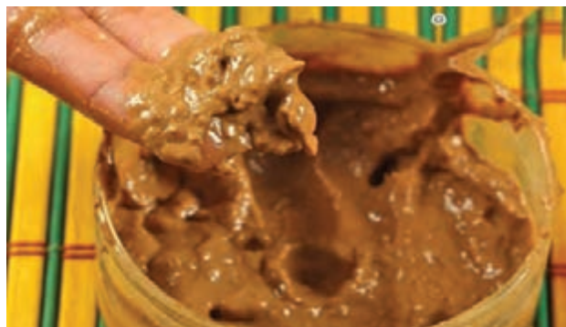
شکل ۵۵- بنتونیت آب جذب کرده و متورم شده
