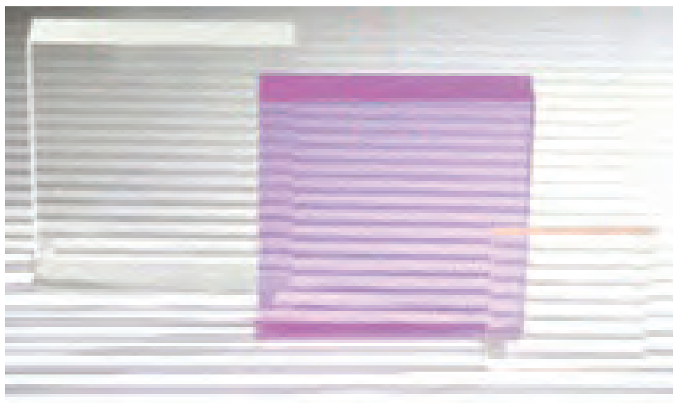
شکل ۱۳- نمونه‌هایی از سرامیک‌های شفاف (YAG)
