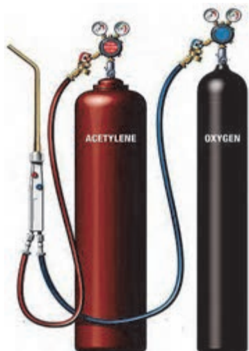
شکل ۲۹- یک واحد جوش کاری گاز
