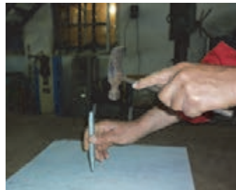
شکل ۱۳- استفاده از سنبه برای نشانه‌گذاری
