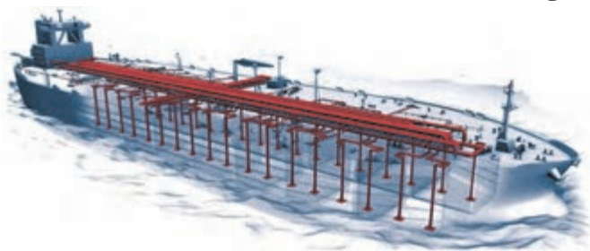
شکل ۲۱- خم کاری لوله در ساختمان یک نفتکش
