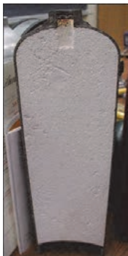
شکل ۷- کیسول برش خورده استیلن
