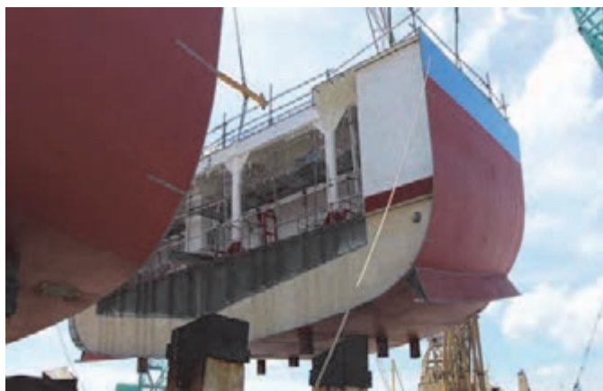
شکل ۸- اتصال بلوک‌های کشتی
