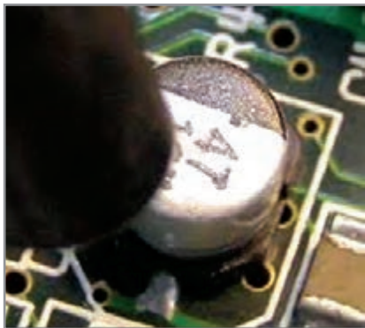
شکل ۲-۳ دمونتاز خازن سرامیکی و الکتrolیت SMD
