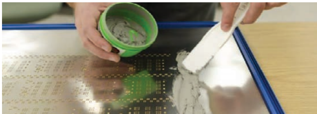
شکل ۱۲-۳ خمیر اندود کردن لحیم به کمک شابلون
