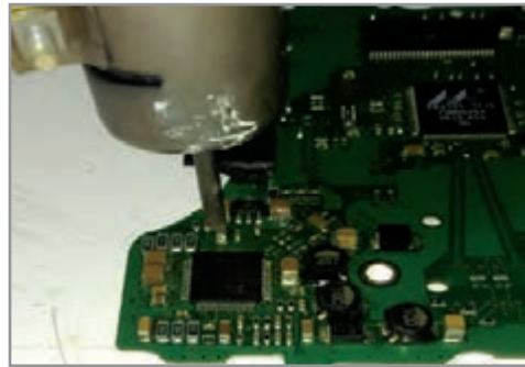
شکل ۲-۴ دمونتاز آی سی های چهار طرفه (خرچنگی)
