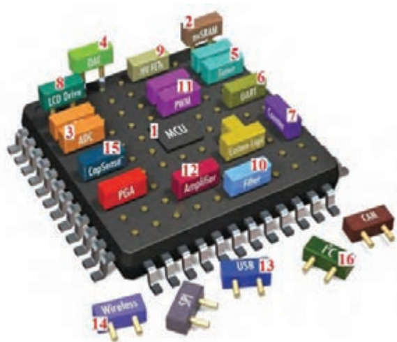
ب) ساختار داخلی میکروکنترلر ARM
