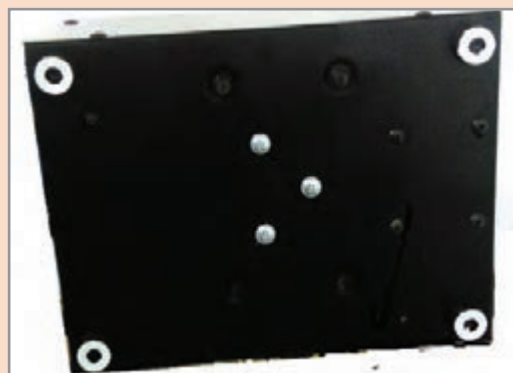
شکل ۱-۴ سه پیچ قفل کننده کمپرسور به بدنه
