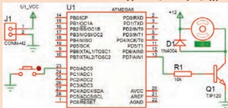
شکل ۷-۳۳ مدار کنترل موتور توسط میکروکنترلر
