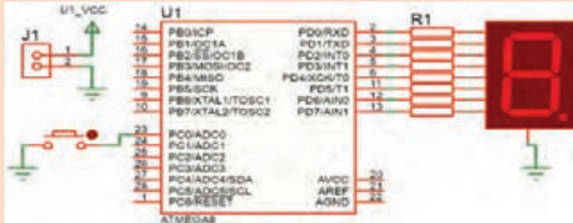
شکل ۷-۳۸ مدار شمارنده یک رقمی
